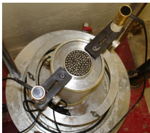
Figura 3.20: Fixação dos LVDTs ao cabeçote (vista superior).
