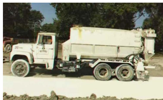
Figura 2.20: Espalhador mecânico para a aplicação da cal em pó (NLA, 2004).
