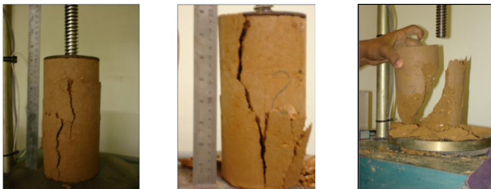
Figura 4.18: Ruptura dos corpos de prova submetidos ao ensaio de RCS.
