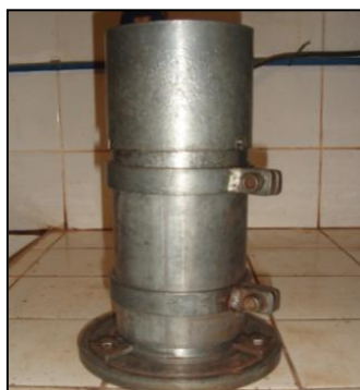
Figura 3.14: Molde cilíndrico tripartido usado no ensaio de compressão simples.
