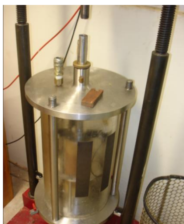
Figura 3.22: Colocação do cilindro da célula triaxial.
