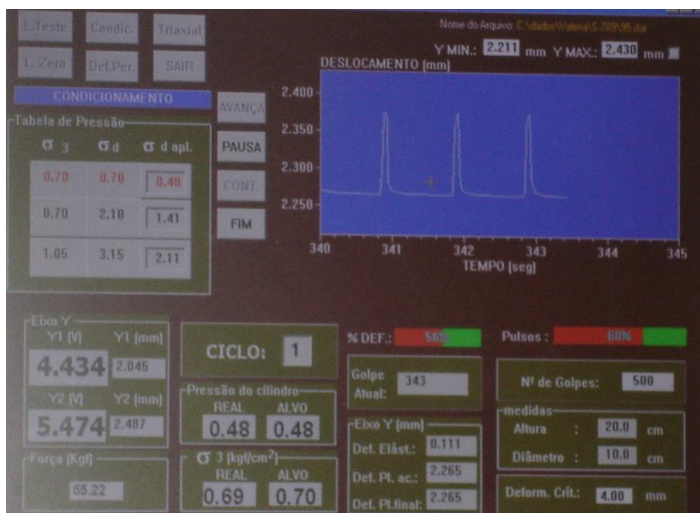
Figura 3.16: Tela gerada pelo SiCAEP durante a realização do ensaio triaxial.
