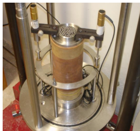
Figura 3.21: Fixação dos LVDTs ao cabeçote (vista frontal).
