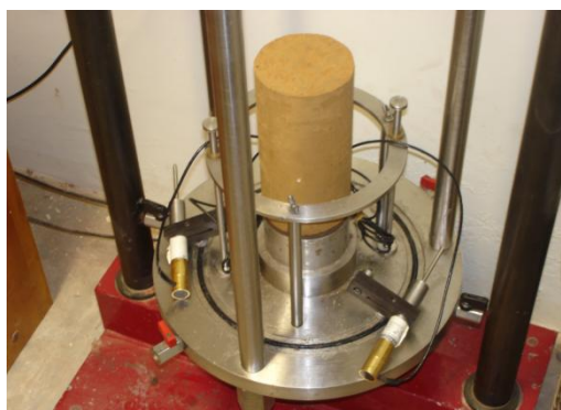
Figura 3.18: Colocação do corpo-de-prova (CP) sobre a pedra porosa.
