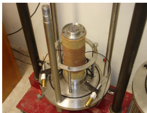
Figura 3.19: Colocação do cabeçote sobre o CP.
