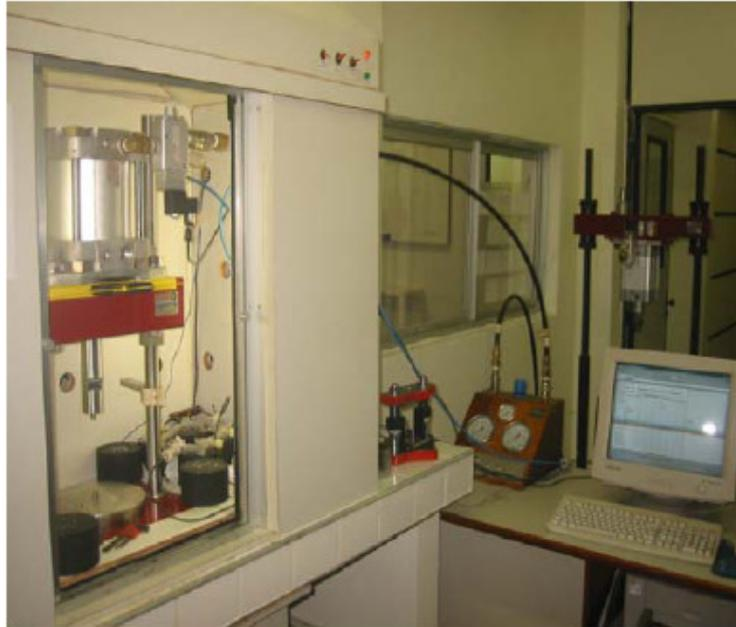
**Figura 5.3:** Equipamento de carga repetida LMP/UFC.
