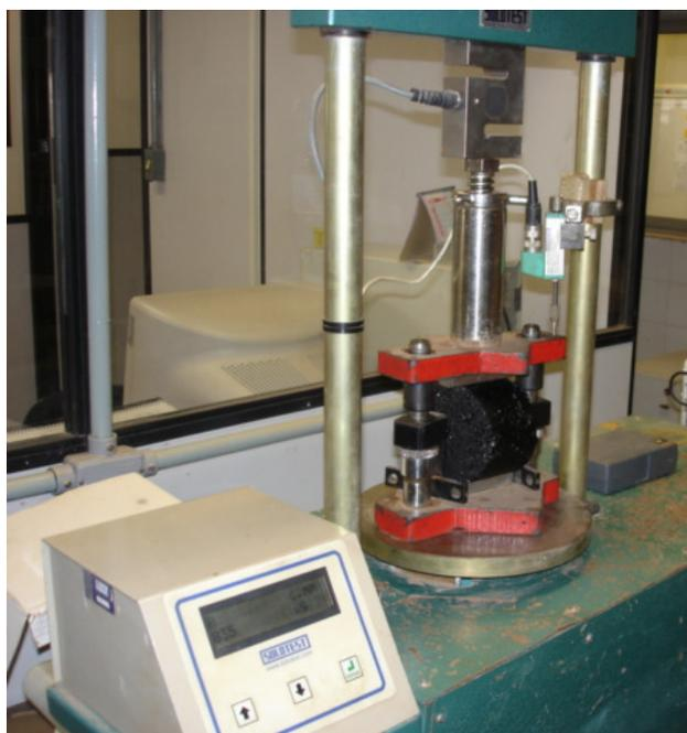
**Figura 5.1:** Prensa mecânica utilizada para realização dos ensaios de resistência à tração.
