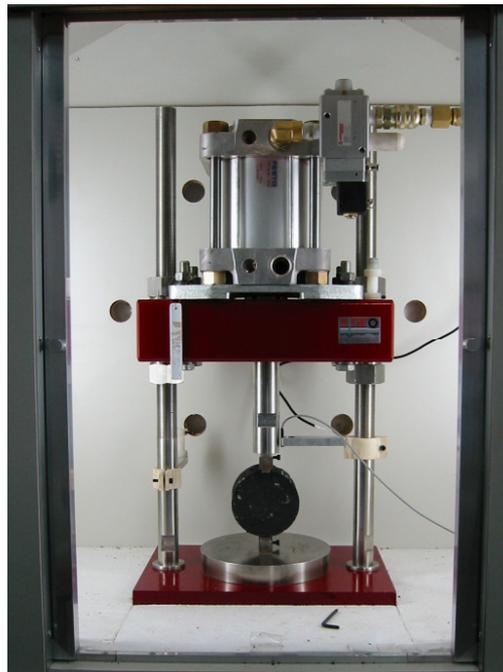
**Figura 5.6:** Equipamento de fadiga por compressão diametral a tensão controlada LMP/UFC.
