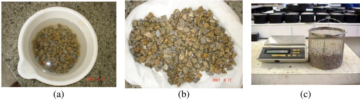
**Figura 3.3:** Etapas do ensaio de densidade de agregado graúdo.
