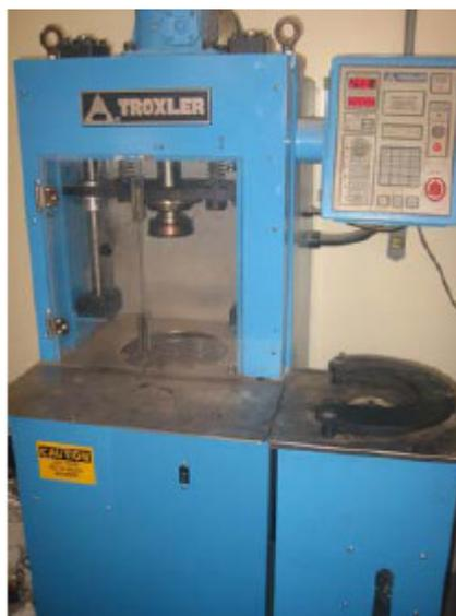
**Figura 4.9:** Compactador giratório LMP/DET/UFC – Troxler 4140.
