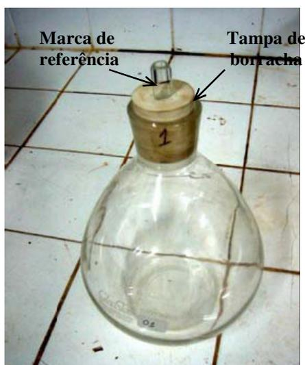
**Figura 2.8:** Ilustração da tampa de borracha com orifício preenchido com vidro de diâmetro reduzido (Fonte: VASCONCELOS, 2004).
