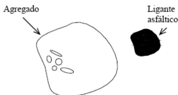
**Figura 2.7:** Ilustração do volume considerado na determinação da densidade real de agregados e ligante asfáltico (Fonte: VASCONCELOS, 2004).
