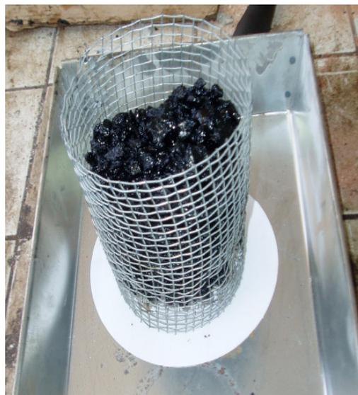
**Figura 4.3:** Cesta usada no ensaio de escoamento de misturas asfálticas não compactadas (AASHTO T 305/97).
