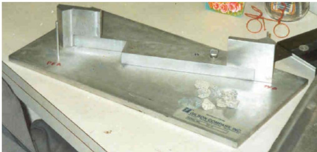
**Figura 3.4:** Paquímetro para determinação da lamelaridade de agregado graúdo.
