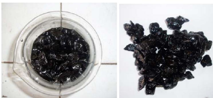
**Figura 3.2:** Etapas do ensaio de adesividade realizado para a brita ¾”.
