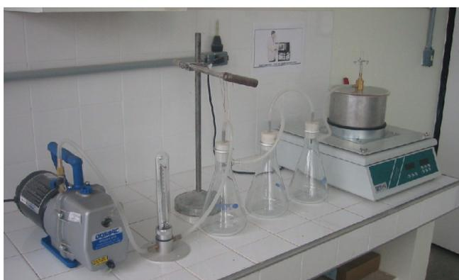
**Figura 2.9:** Equipamento para ensaio de DMT com aplicação de vácuo – LMP/UFC.
