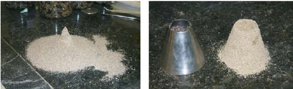
**Figura 3.5:** Passos para determinação da densidade de agregado miúdo (ASTM C 127-07): (a) material muito seco e (b) deslizamento ótimo da amostra.
