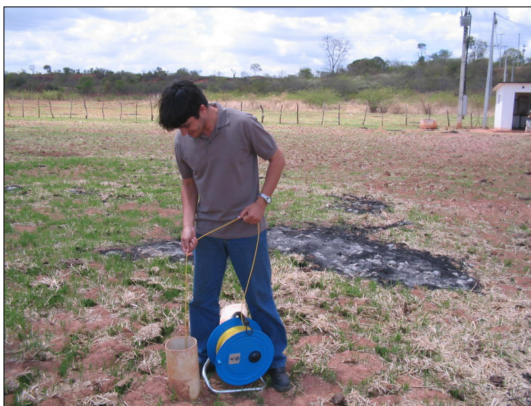
Foto 8.1 - Exemplificação da tomada do nível estático. (10/12/2005).
