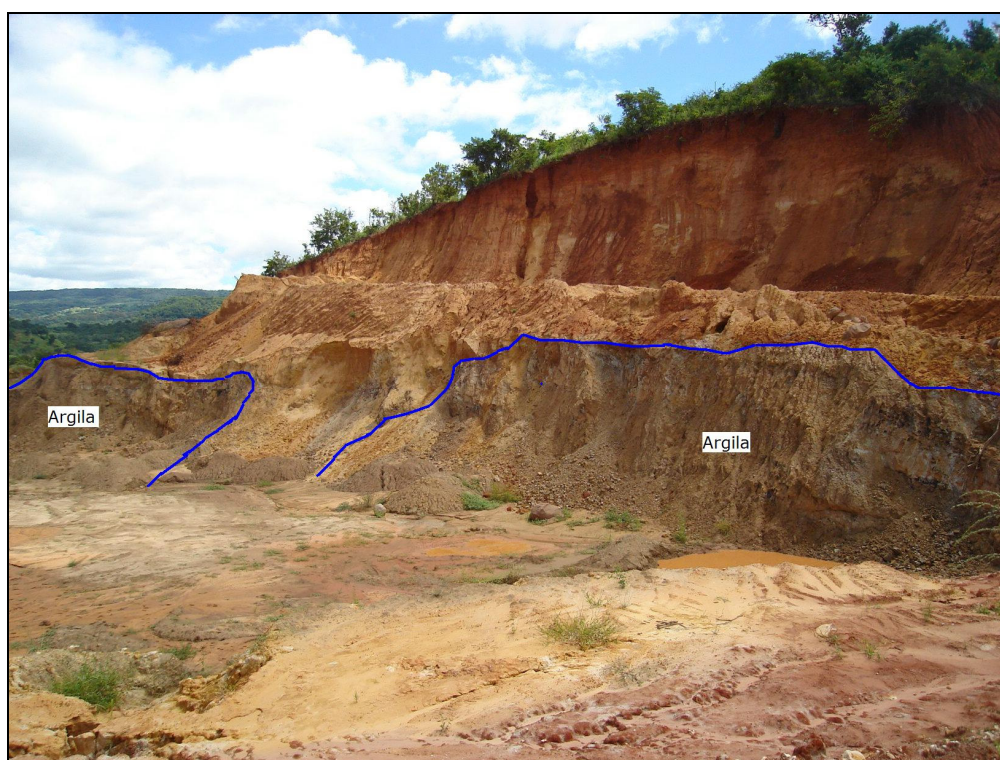
Foto 7.1 - Afloramento da Formação Rio da Batateira, nível de argila, exploração de argila para fabricação de cerâmica vermelha, Barbalha – CE. 454103W / 9203124S. (03/05/2007).
