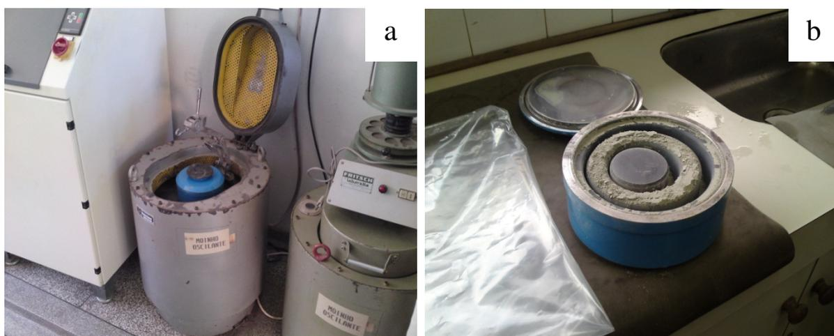
Figura 2.5: Imagem do a) moinho oscilatório utilizado para a moagem da rocha e b) amostra moída com 200 mesh dentro do moedor de ágata.
