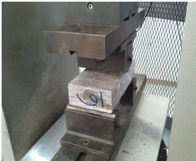
Figura 2.3: Imagem do corpo de prova na máquina para o ensaio de resistência a flexão 3 pontos do Laboratório de Rochas Ornamentais do DPM/IGCE – UNESP/Rio Claro.
