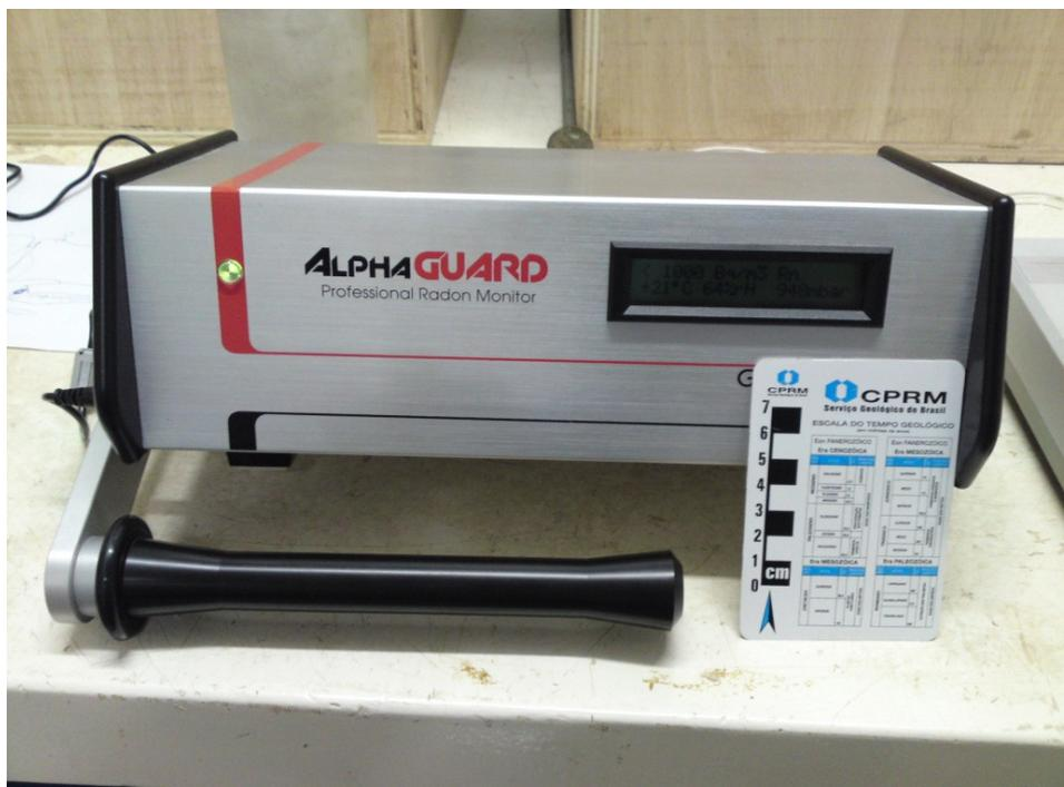
Figura 2.9: Detector de radônio AlphaGUARD utilizado para medição da concentração de radônio.
