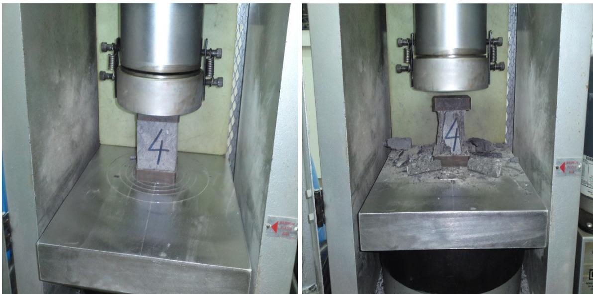
Figura 2.2: Imagem do corpo de prova na máquina de compressão uniaxial do Laboratório de Rochas Ornamentais do DPM/IGCE – UNESP/Rio Claro.
