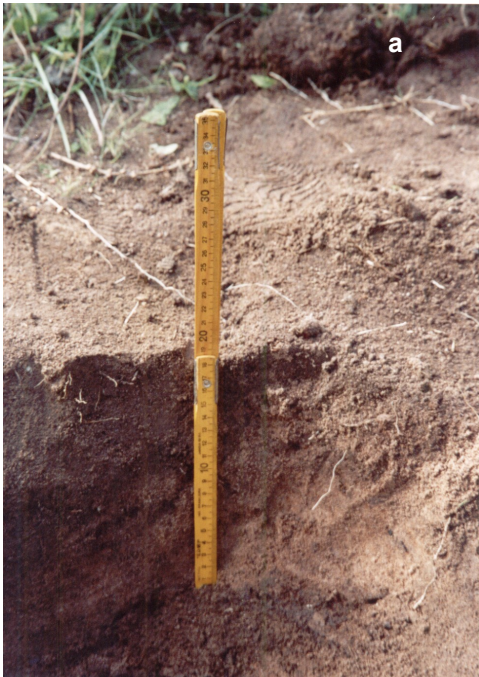
Figura 8.9 – Trincheiras para coleta de amostra na área de cultivo, com 20 cm de profundidade (a) e com 40 cm (b). (10/10/2004).
