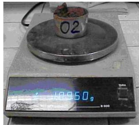
Figura 43 – Pesagem da cápsula com a amostra úmida.
