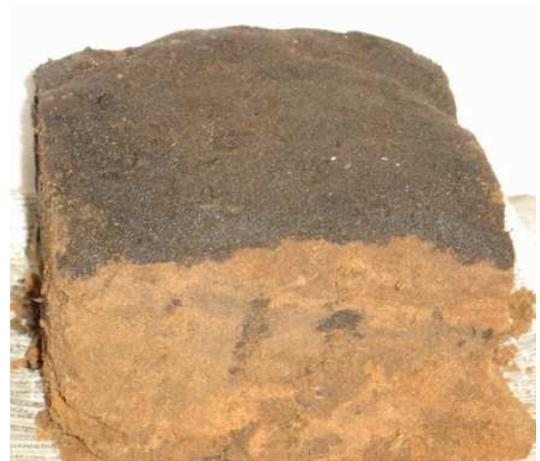
Figura 27– Amostra de solo com óleo infiltrado após 48 horas do derrame.
