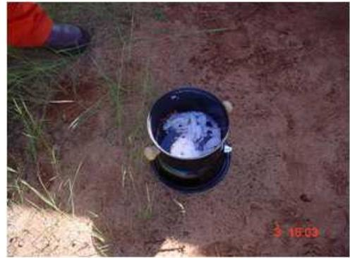
Figura 39a – Parafina sendo dissolvida no fogo para vedar o topo e a base do cilindro.
