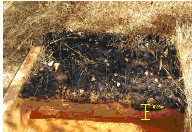
Figura 60b – Ponto MA-02, o óleo infiltrou até a profundidade máxima de 0,05 m.
