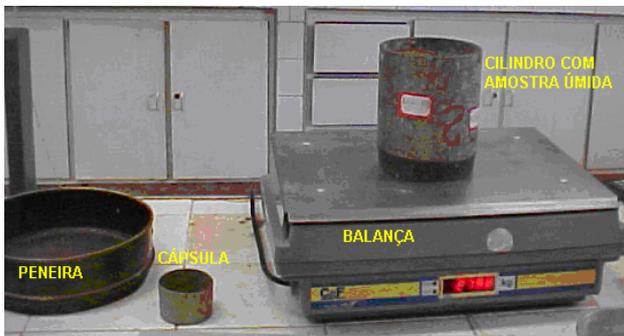
Figura 40 – Pesagem da amostra dentro do cilindro de aço no Laboratório de Mecânica dos Solos da UFC
