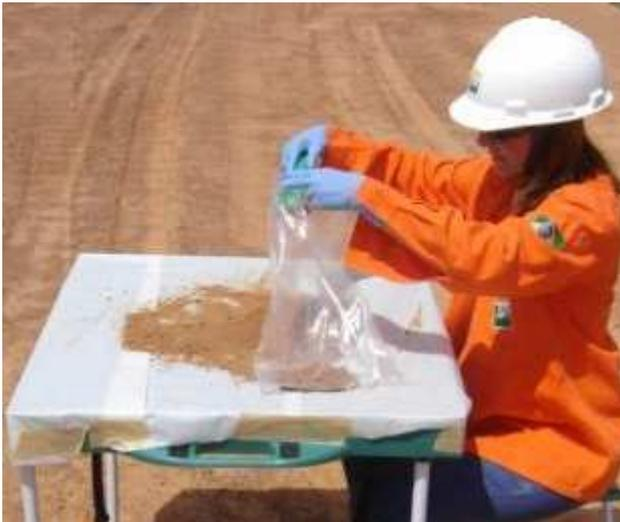
Figura 18 – Coleta de amostras de solo para análise de metais pesados e textura.
