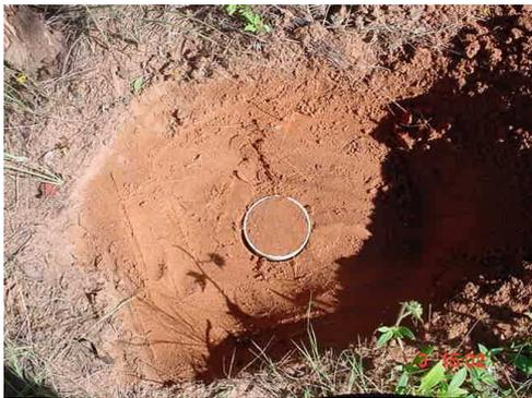
Figura 38– Cilindro de PVC penetrado no solo para coleta de amostras no Campo Fazenda Belém.
