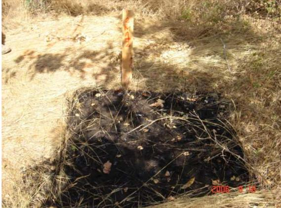
Figura 60a – Ponto MA-02 onde foi simulado derrame de óleo cru. Área de 1m<sup>2</sup>.
