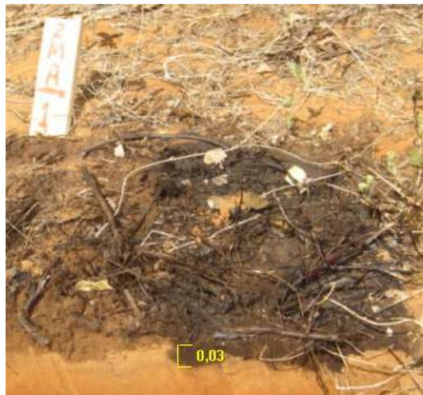
Figura 59 – No ponto MA-01 o óleo infiltrou até a profundidade de 0,03m.
