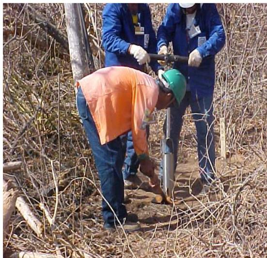
Figura 17 – Perfuração do solo com trado manual para coleta de amostras.
