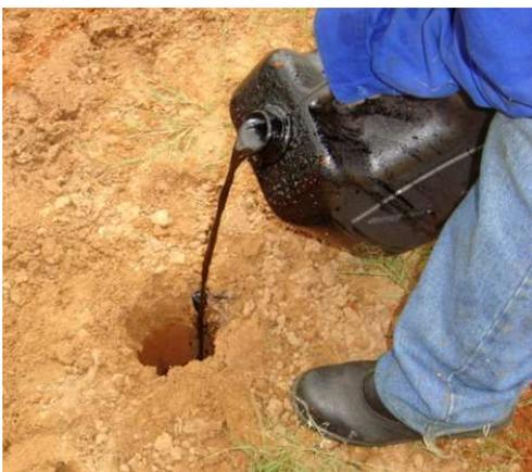
Figura 33– Derrame de óleo em um furo feito a trado manual para determinar a permeabilidade do solo.
