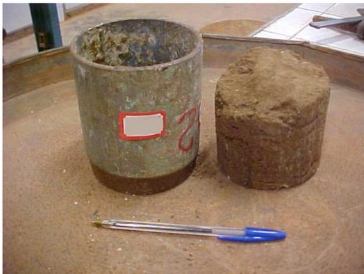
Figura 42– Amostra de solo indeformada retirada do cilindro de aço. Cilindro de 0,20 m de comprimento.
