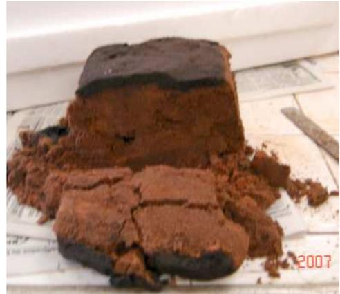
Figura 29 – Corte na amostra para verificar a profundidade da infiltração do óleo.
