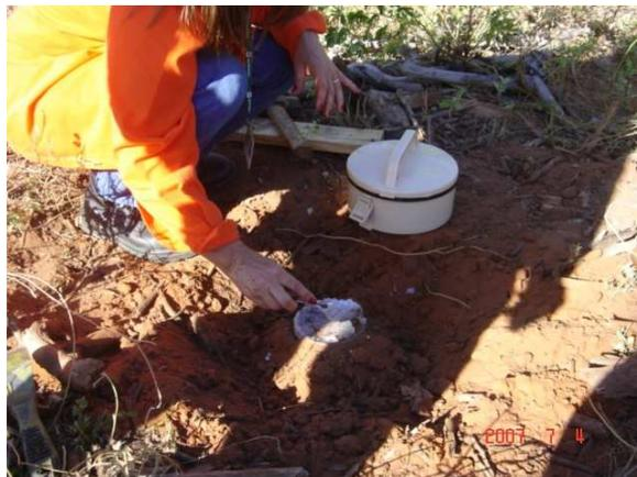
Figura 39b – Parafinando o topo da amostra de solo. A base da amostra no cilindro foi parafinada após a retirada do cilindro do solo.
