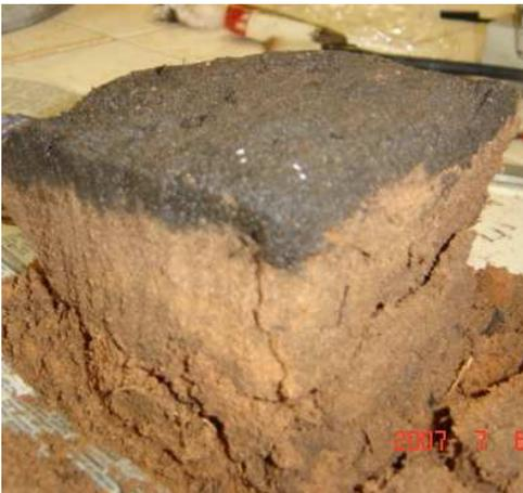
Figura 30 – Corte na amostra de solo mostrando a profundidade de infiltração do óleo.
