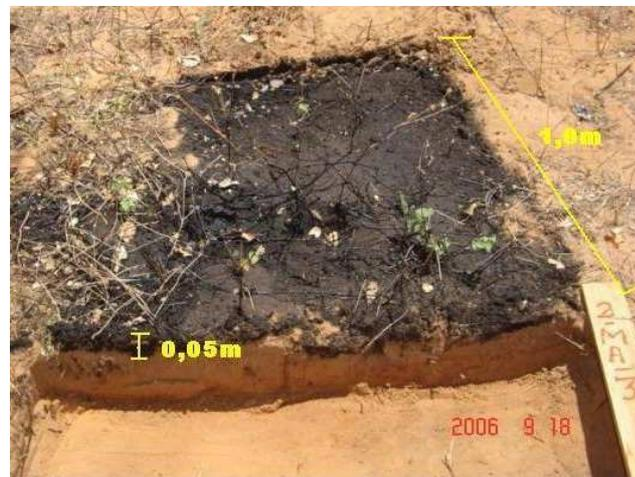
Figura 61 – Ponto MA-03, onde foi derramado óleo à temperatura de 47°C, evidenciando a profundidade máxima de infiltração, correspondendo a 0,05 m.
