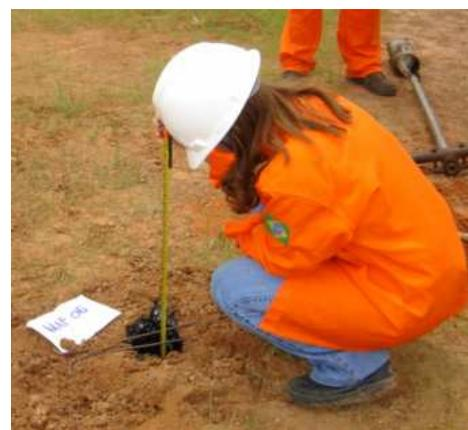
Figura 34– Medida da distância ( $P$ ) entre a superfície do óleo e o topo do furo no solo.
