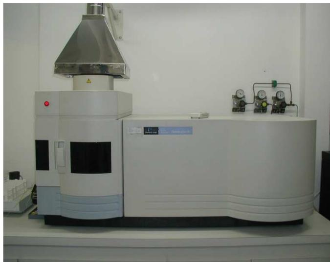
Figura 44 – ICP-OES; Inductively Coupled Plasma-Atomic Emission Spectrometry para análise de metais pesados.
