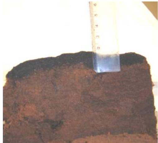
Figura 31 – Medida da profundidade de infiltração do óleo no solo de 1,7cm.
