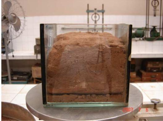
Figura 24 – Amostra de solo indeformada dentro do recipiente de vidro de dimensão. 0,20mX0,20mX0,20m.
