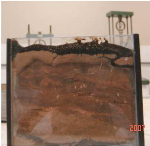
Figura 26– Recipiente com a amostra de solo com óleo com dimensão 0,20mX0,20mX0,20m.
