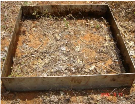
Figura 20 – Armação de aço inoxidável de 1mX1mX0,20m, colocada no solo no campo Fazenda Belém.
