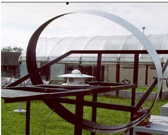
Figura 2.5 - Medição da radiação difusa via sombreamento de um piranômetro [18].
