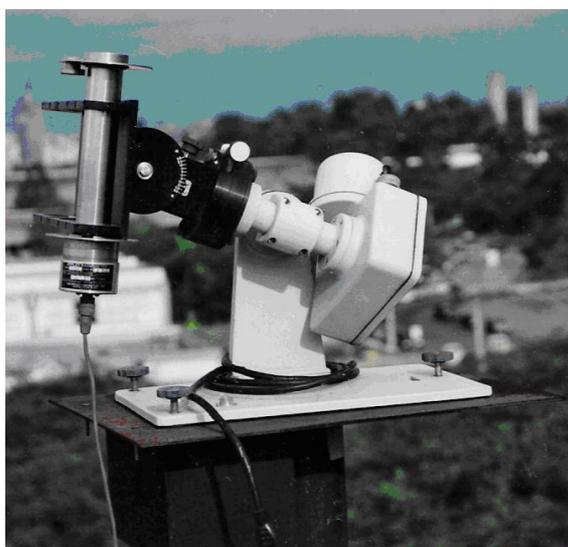
Figura 2.6 - Piroheliômetro de Angstrom [18]
