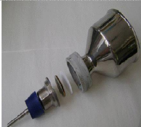
Figura 16 – Componente da unidade de filtração. Fonte: CETESB, 2011.
