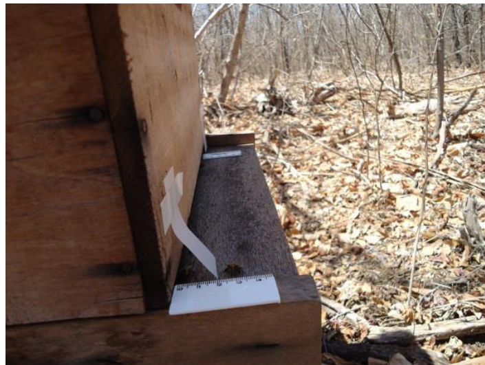
Figura 9- Deslocamento do papelin em função da intensidade de circulação de ar feita pelas abelhas para ventilar o interior da colmeia.
