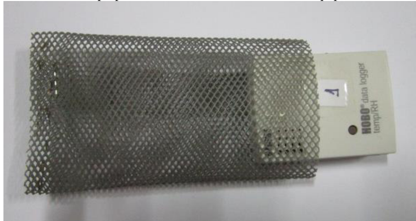
Figura 5- Proteção do Data Logger com gaiola de tela plástica antes da inserção nas colmeias visando evitar que as abelhas propolizem as aberturas dos sensores do equipamento.
