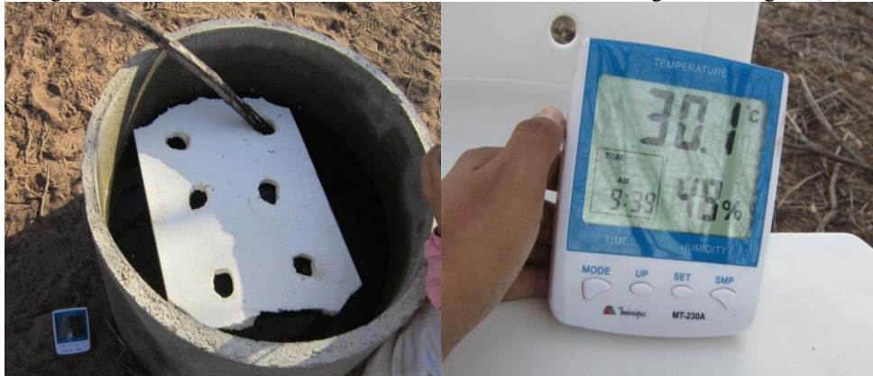
Figura 17- Coleta dos dados de temperatura e umidade relativa do ar próximo à fonte de água. (A) Termo-higrômetro instalado ao lado do bebedouro, Detalhe do termo-higrômetro digital (B).
