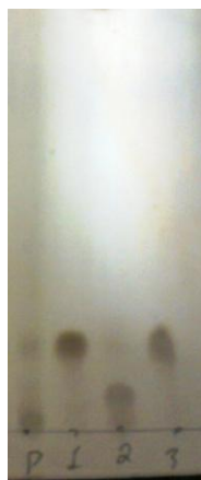
Figura 7 – Placa de análise por Cromatografia em Camada Delgada (CCD) das substâncias MOS-ES-1 (1), MOS-ES-2 (2) e MOS-ES-3 (3). P = purga da coluna; eluente = \text{CH}_2\text{Cl}_2/\text{MeOH} (95:5) e revelador = solução de vanilina.
