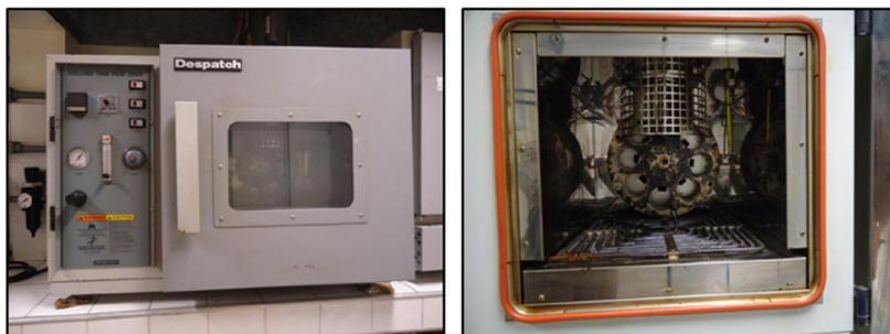
Em recipientes de vidro, padronizados, foram pesados 35 g de CAP, e deixados em repouso por uma hora. Em seguida, os recipientes foram colocados no disco giratório da estufa. As amostras foram submetidas a fluxo de ar 4,0 mL de ar durante 85 minutos, na temperatura de 163°C e, posteriormente, foram retiradas e armazenadas para análise.
