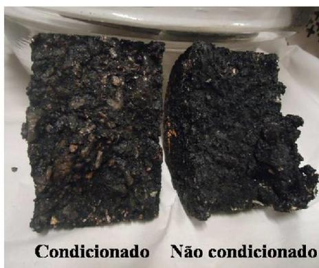
É possível perceber, na imagem da Figura 4.40, que o corpo de prova submetido ao condicionamento apresenta pontos amarelados, decorrentes da remoção do ligante da superfície dos agregados, em virtude da ação deletéria da água, durante o processo de condicionamento.
