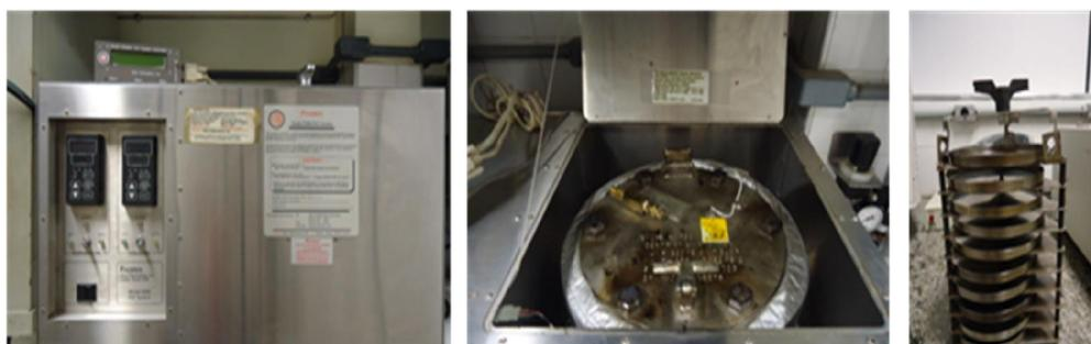
O ensaio em estufa PAV deve ser precedido do ensaio em RTFOT, pois, antes de ser aplicado no pavimento, o ligante é misturado com os agregados, e o envelhecimento ocorrido na mistura do CAP com os agregados é simulado pela estufa RTFOT.
