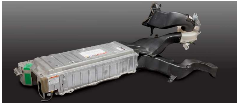
Figura 1.12 – Banco de baterias Ni-Mh.
