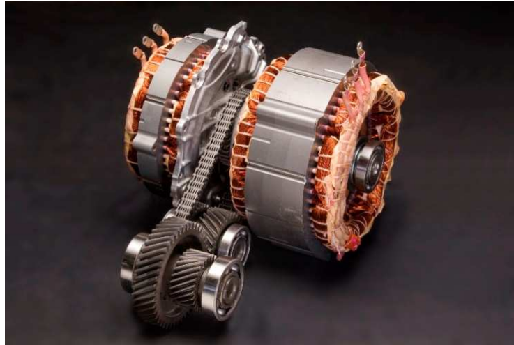
Figura 1.3 – Motor elétrico de propulsão para veículos híbridos.
