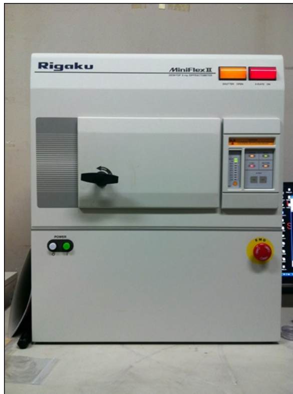
Figura 18: Difratômetro de Raios-x, modelo Rigaku MiniFlex II, usado para caracterização do cristal.
