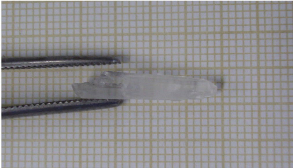
Figura 20: Foto de um dos exemplares de cristal de L-alanina com ácido oxálico crescido neste trabalho, a face mostrada corresponde ao plano (002), então o eixo c é perpendicular à página.
