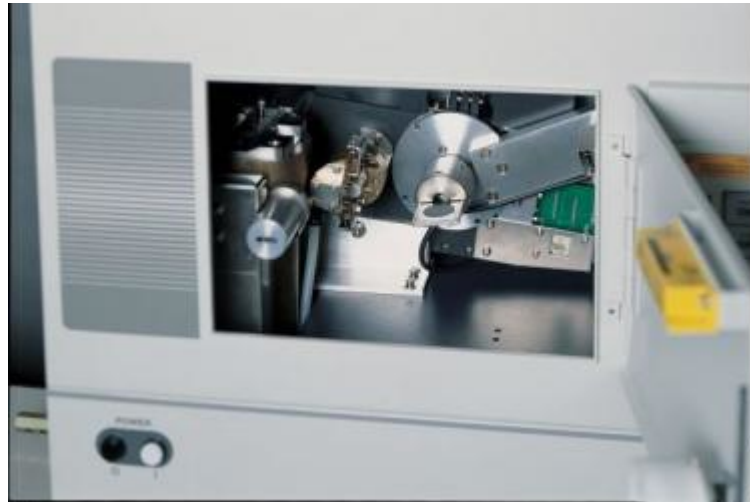
Figura 19: Detalhe mostrando o goniômetro do Difratorômetro de Raios-x, modelo Rigaku MiniFlex II.
