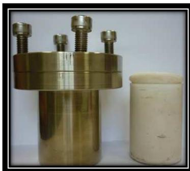
Figura 3: Autoclave ao lado do copo de Teflon®.
