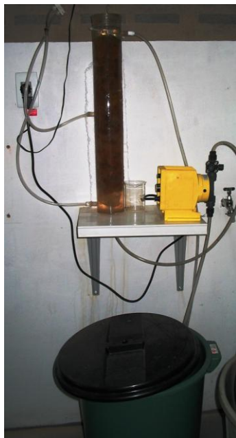
Figura 7. Sistema de tratamento pelo reator aeróbio de leito fixo e fluxo contínuo ascendente inoculado com o fungo Aspergillus niger .
