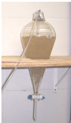
Figura 9. Funil com aeração para eclosão dos cistos de Artemia sp.
