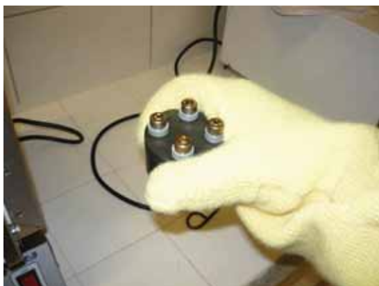
Figura 44: A imagem da esquerda mostra o pastilhador recém retirado do forno e na figura da direita o reaperto dos parafusos após fixar o pastilhador.
