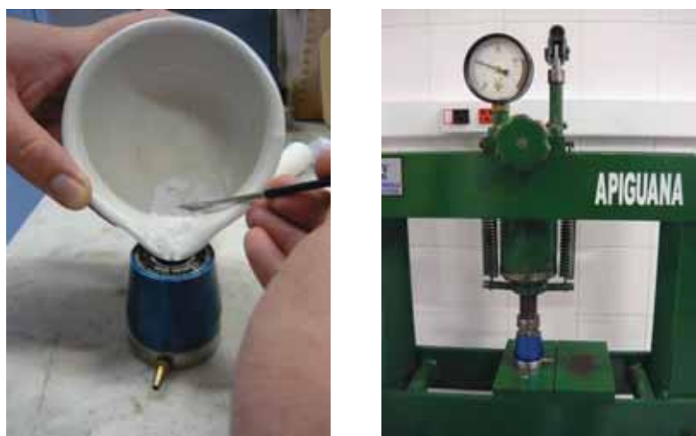
Figura 40: A imagem da esquerda mostra o preenchimento do pastilhador e a imagem da esquerda a prensagem.
