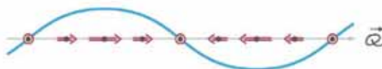
Figura 14: Onda sinusoidal de densidade de spins, em que os spins apontam em uma direção mas variam em magnitude. Figura extraída da referência (47).
