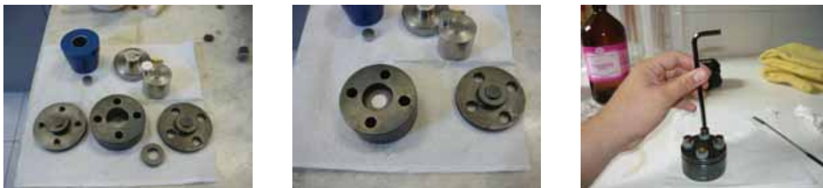
Figura 41: A foto da esquerda mostra o pastilhador comercial (parte superior) e o de fabricação própria (parte inferior), na figura central a pré-forma já encontra-se acomodada no nicho central, e na figura da direita observa-se a colocação dos parafusos no pastilhador.
