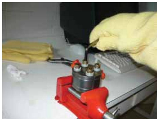
Figura 44: A imagem da esquerda mostra o pastilhador recém retirado do forno e na figura da direita o reaperto dos parafusos após fixar o pastilhador.
