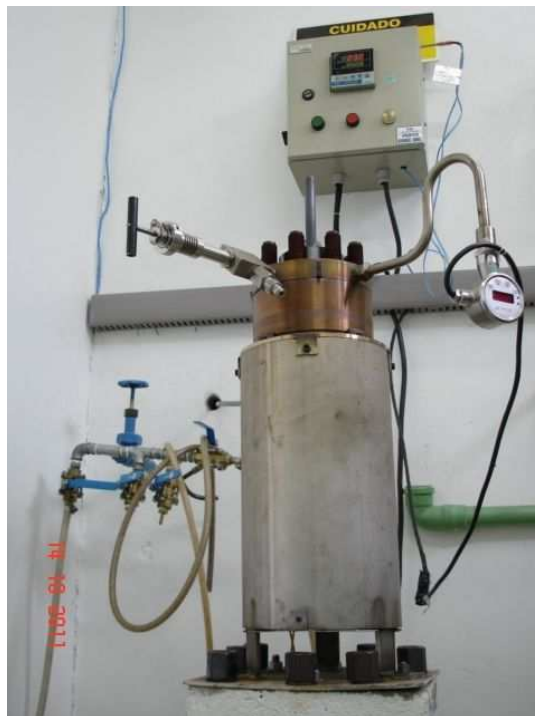
Fig. 3.1 - Autoclave onde foram realizados os experimentos de hidrogenação no laboratório de Materiais das Indústrias Nucleares do Brasil.
