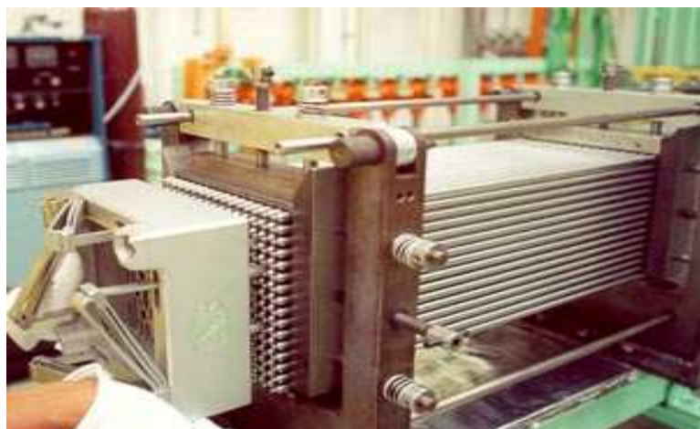
Fig. 2.4 - O elemento combustível produzido pela INB para a Usina Angra 1 é de tecnologia Westinghouse. Seu conjunto possui 235 varetas combustíveis, oito grades espaçadoras, 20 tubos guias, um tubo de instrumentação e dois bocais (um inferior e um superior)[8].
