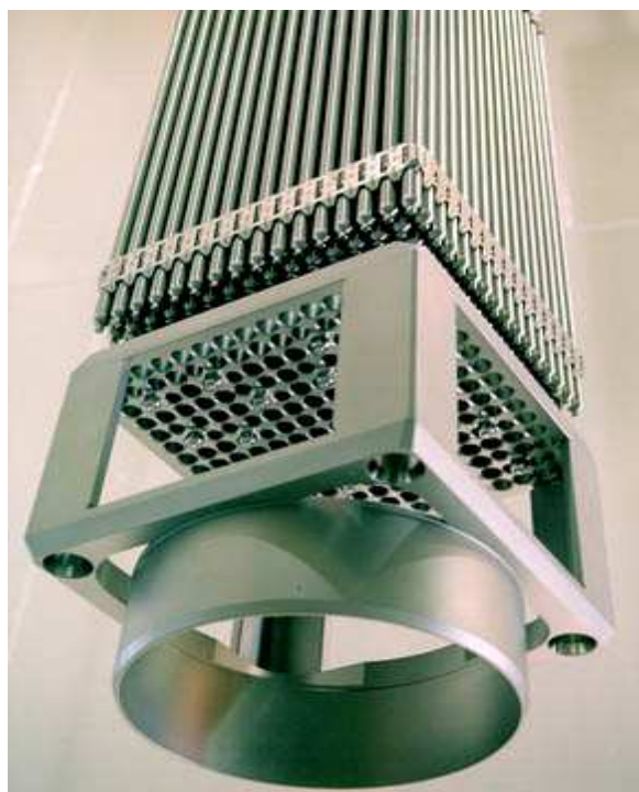
Fig.2.2 - Elemento combustível fabricado para abastecer Angra 2 é de tecnologia Siemens/Areva e seu conjunto possui 236 varetas combustíveis. Conta ainda com nove grades espaçadoras, 20 tubos guias e dois bocais (um inferior e um superior)[8].
