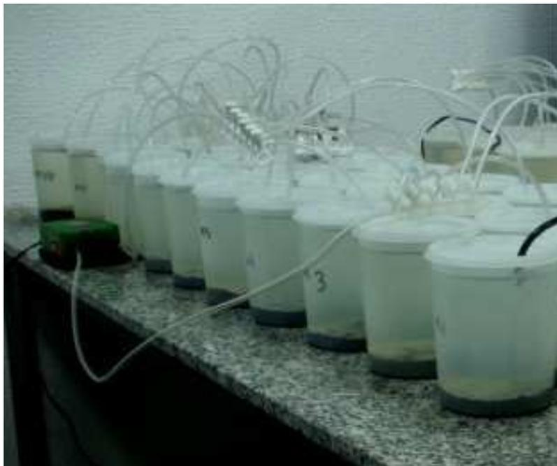
FIGURA 6 – Sistema de exposição do teste de toxicidade com sedimento integral
