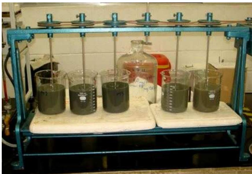
FIGURA 10 – Agitador mecânico utilizado no preparo dos elutriatos
