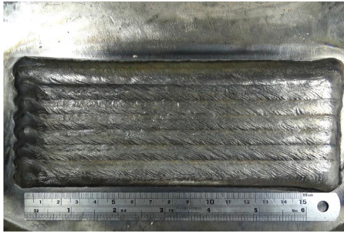
Figura 37. Aspecto do acabamento superficial do revestimento E85.
