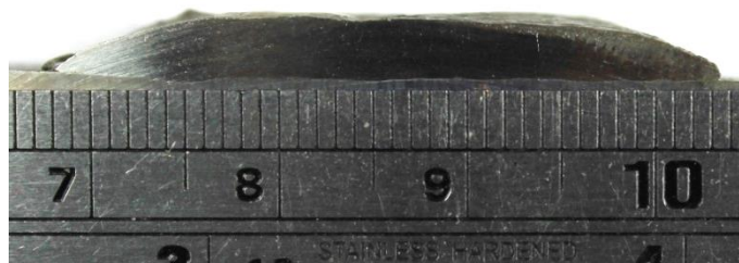
Figura 35. Seção transversal da sobreposição de dois cordões soldados na etapa preliminar com tecimento espiral e amplitude de tecimento de 6 mm.
