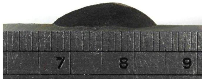
Figura 36. Seção transversal do cordão soldado na etapa preliminar com tecimento triangular e amplitude de tecimento de 8 mm.
