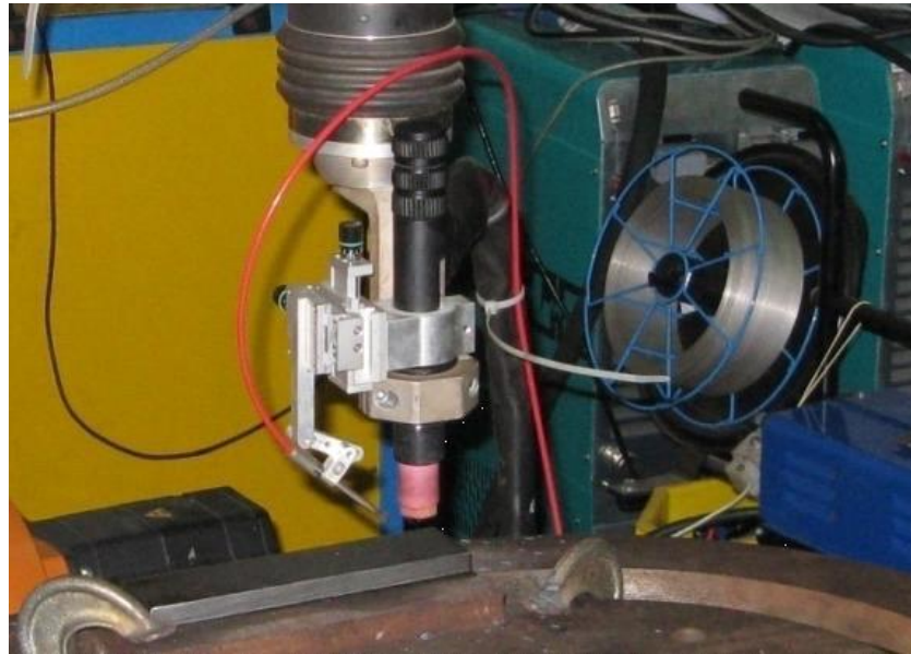
Figura 23. Tocha TIG, mecanismos de adição de arame e o dispositivo de alinhamento.
