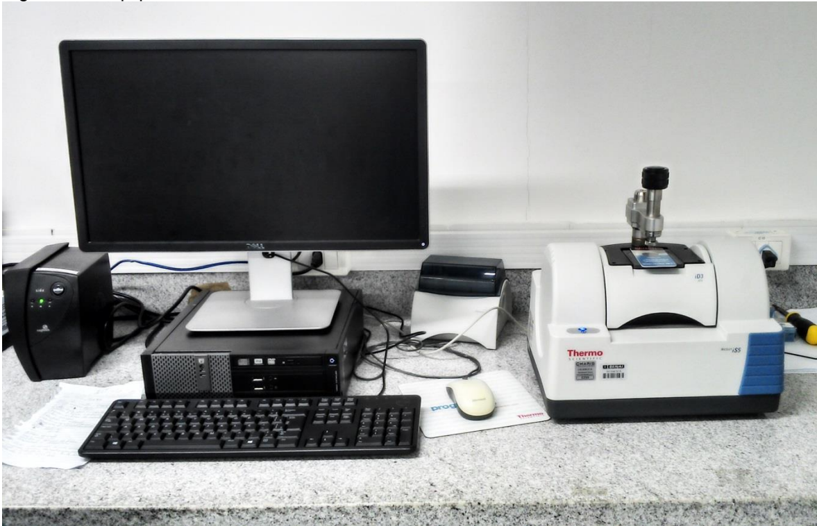
Figura 12 – Equipamento de infravermelho
