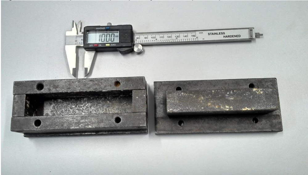
Figura 14 – Molde prismático para produção dos corpos de prova
