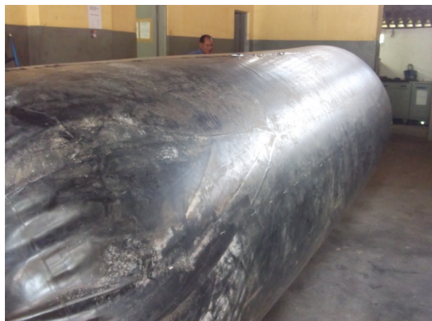
Figura 4.15: Teste de vazamentos do biodigestor
