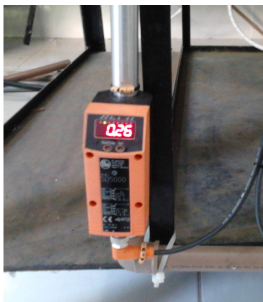
Figura 4.8: Sensor de vazão SD 5000
