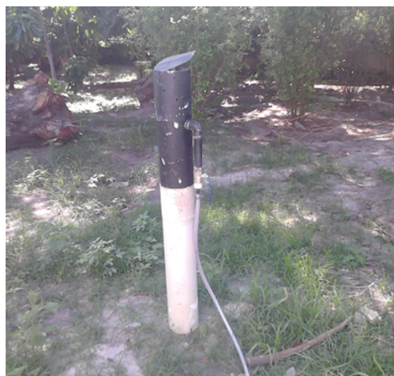
Figura 4.20: Queimador da planta de biogás do LEA.
