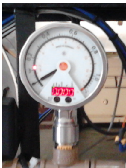
Figura 4.7: Sensor de pressão PG2457
