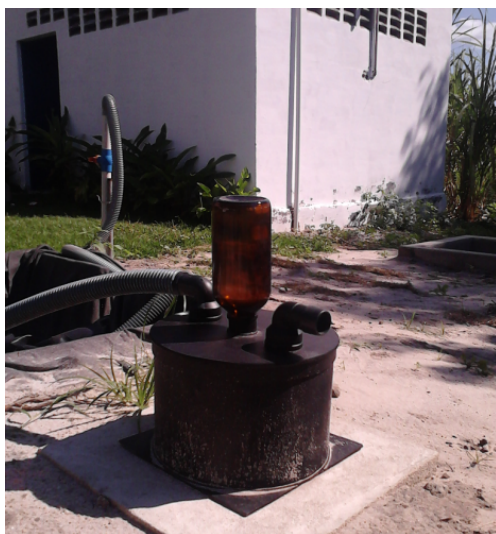
Figura 4.19: Borbulhador da planta de biogás do LEA.
