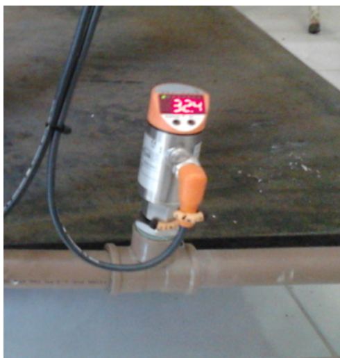
Figura 4.6: Sensor de temperatura TN2531
