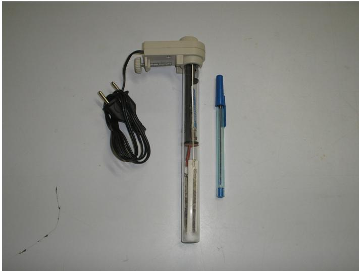
Figura 12. Aquecedor termostato utilizado no desenvolvimento de juvenis recentes da lagosta *Panulirus argus*, sob diferentes temperaturas em ambiente controlado.
