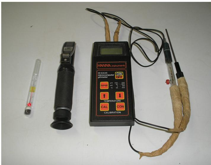
Figura 16. Detalhe dos aparelhos utilizados para o monitoramento dos parâmetros físico-químicos da água de cultivo dos juvenis recentes da lagosta *Panulirus argus*, mantidos sob diferentes temperaturas em laboratório.
