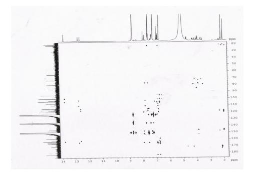
**Figura 47** - Espectro de correlação heteronuclear a mais de uma ligação (HMBC, 125, 500 MHz, piridina- $d_5$ ) de SMRAC5.
