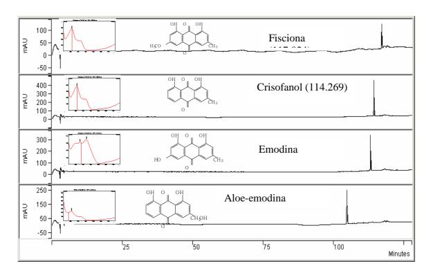
**Figura 60**- Espectro na região do UV e cromatograma de padrões de antraquinonas isoladas de *Senna martiana*
