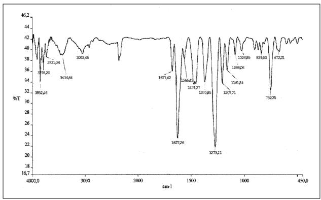
Figura 16 – Espectro de absorção na região do IV (KBr) de SMR3
