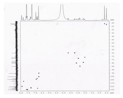
Figura 44 - Espectro de correlação heteronuclear a uma ligação (HSQC) de SMRAC5
