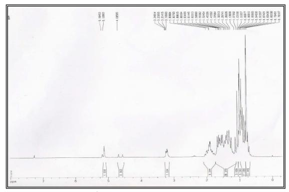
**Figura 54** - Espectro de RMN  $^1$ H (500 MHz, CDCl $_3$ ) de SMF6
