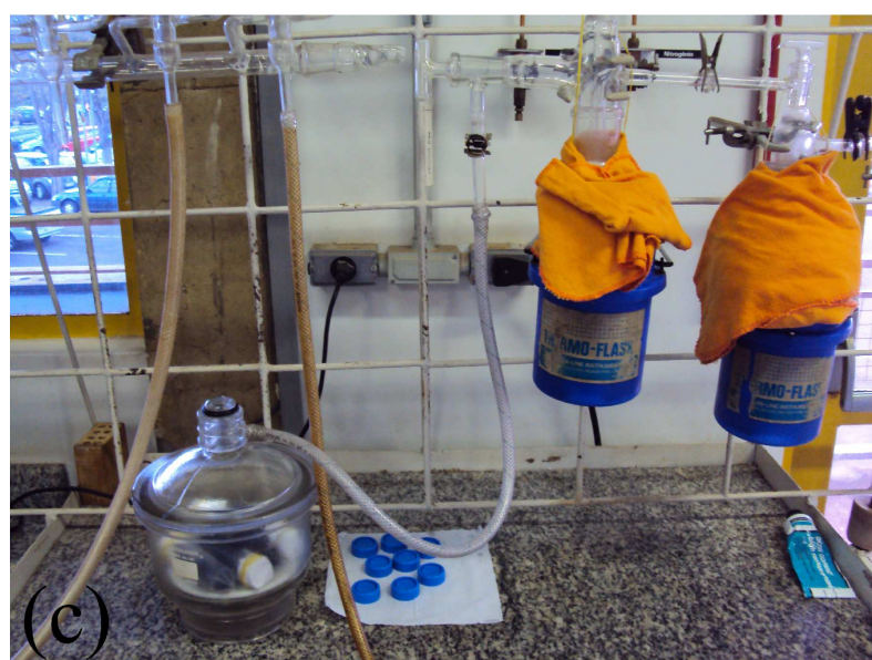
Figura 19: Ilustração das três principais etapas do processo de purificação dos nanotubos de carbono. Em (a) o sistema está sujeito ao refluxo, em (b) a amostra passa pela etapa de lavagens com água deionizada e em (c) a umidade presente nas amostras é removida sob condições de vácuo.
