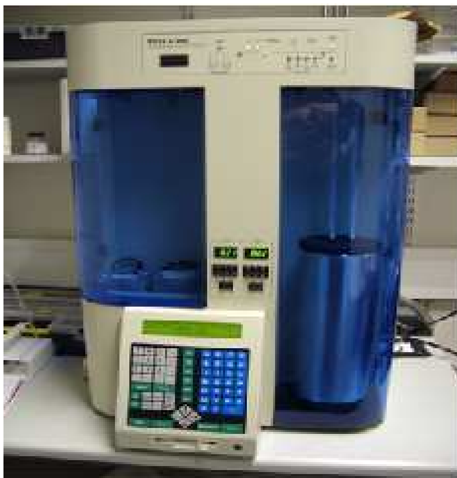
Figura 23: Modelo do analisador de área superficial da Quantachrome utilizado nas medidas de BET.
