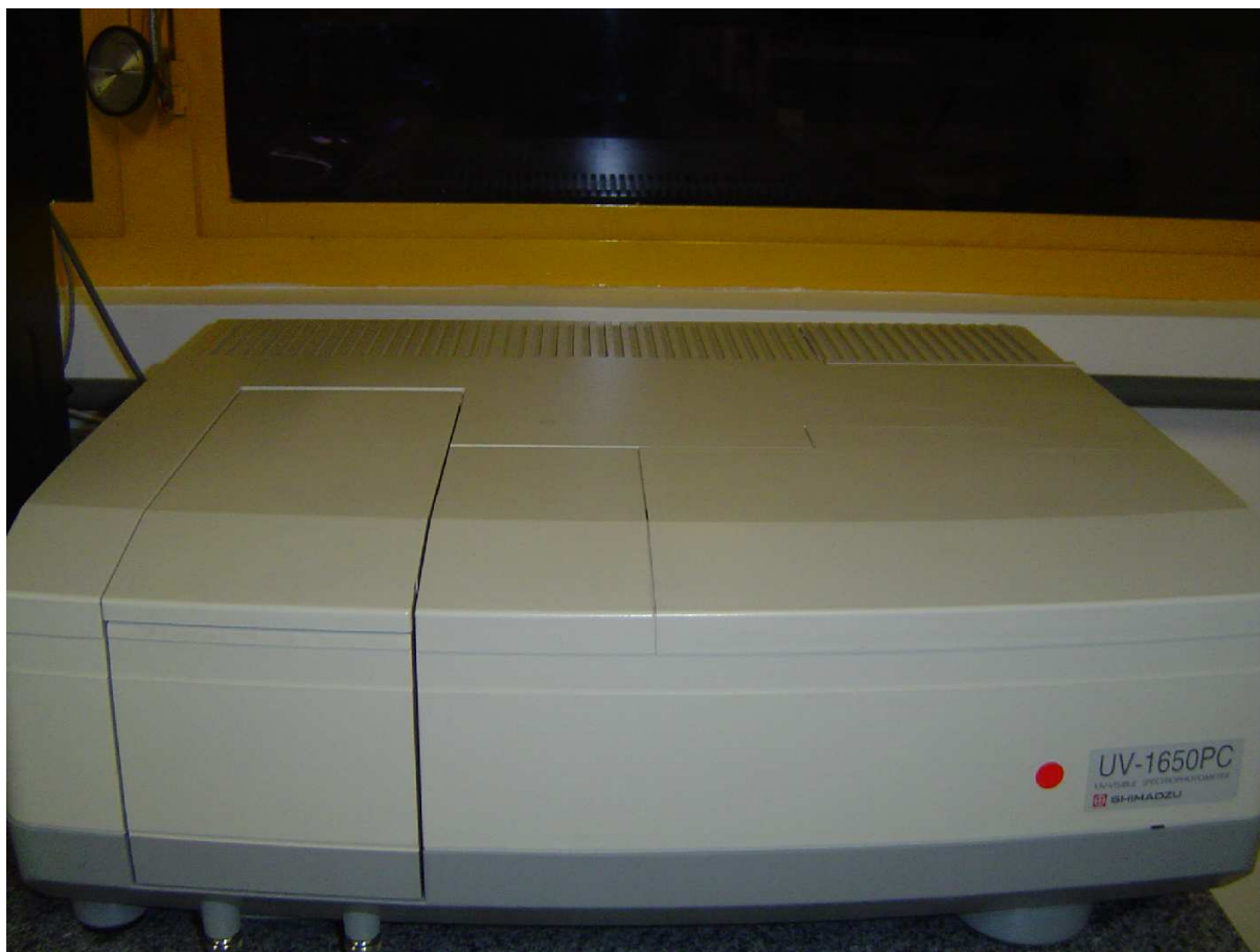
Figura 22: Modelo do espectrofotômetro Shimadzu UV-1659PC utilizado na realização das medidas de absorbância.
