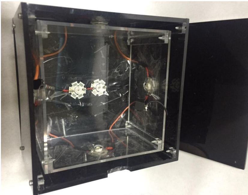
Figura 1. Aspecto interno do dispositivo de LED composto por 8 LEDs com potência de 1W utilizado para o experimento.
