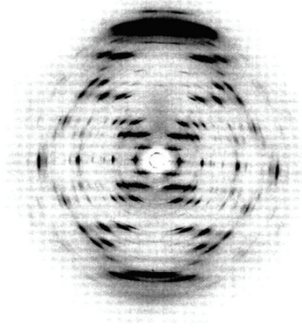
Figura 2: Padrão de difração de raios X em fibras constituídas por moléculas de DNA. A localização dos máximos (regiões claras) e dos mínimos (regiões escuras) de intensidade desses raios é utilizada para a determinação da posição de cada átomo ou centro dipersor da molécula. Assim, consegue-se determinar a estrutura da molécula. Extraído de Neidle (1999).
