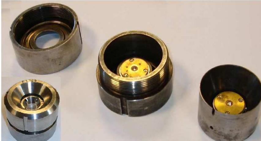
Figura 11 - Vista ampliada dos diamantes e da gaxeta
