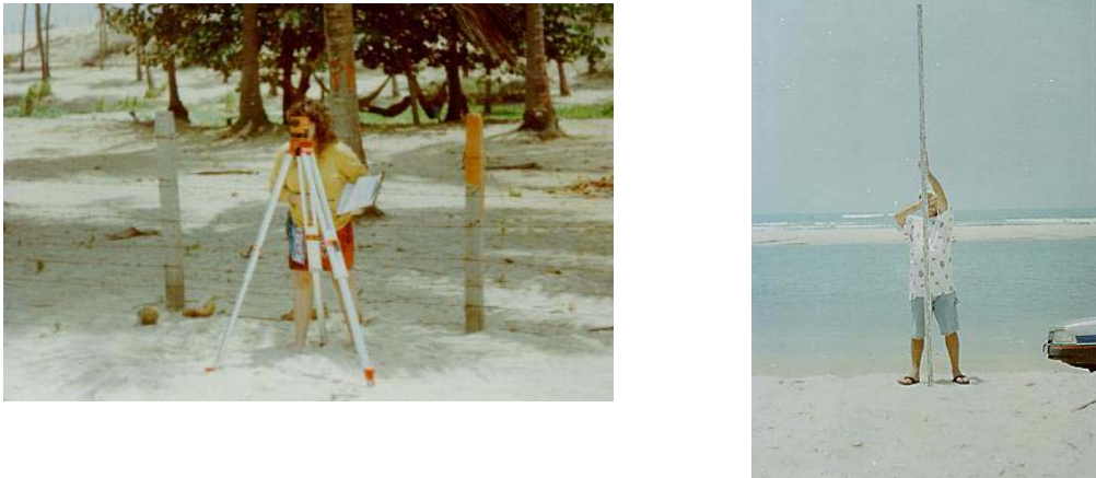
Figura 12 – Procedimento de campo para realização dos perfis de praia. (Fonte: Magalhães, 2000).
