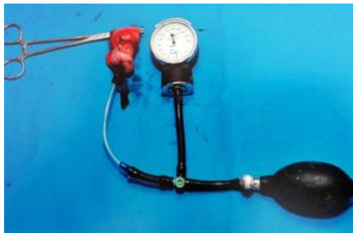
Figura 8 – Sistema para teste de pressão ruptura confeccionado com segmento intestinal do animal nº 21 do grupo II
