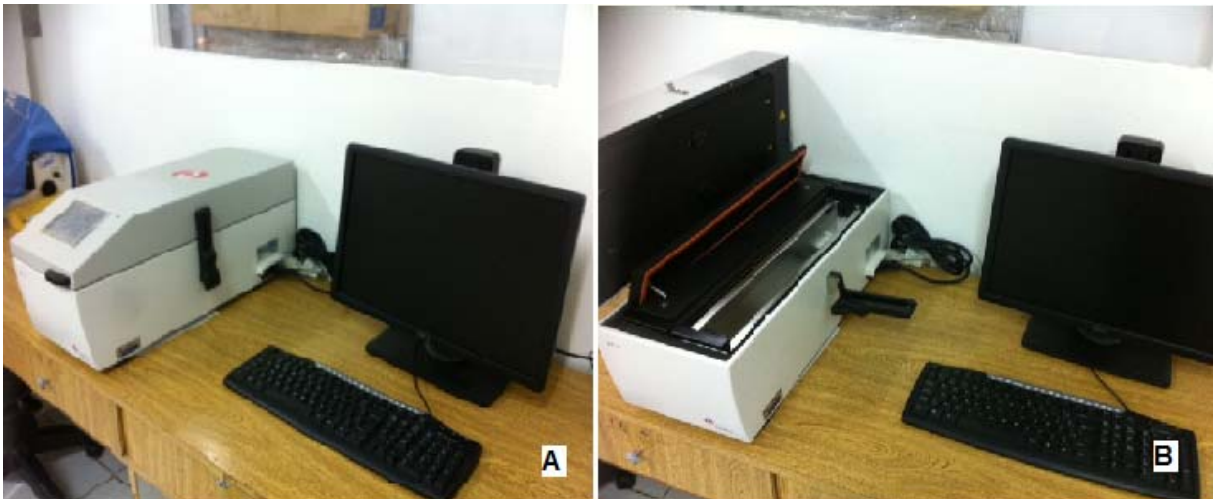
Figura 5: A foto A ilustra o aparelho Dako ® PT Link , interligado ao computador, onde é realizada a recuperação antigênica com temperatura monitorizada e controlada automaticamente. A foto B mostra o aparelho aberto, onde é possível visualizar os 2 tanques de módulo pré-tratamento independentes, com capacidade de 24 lâminas por tanque. Fonte: Dados do autor.
