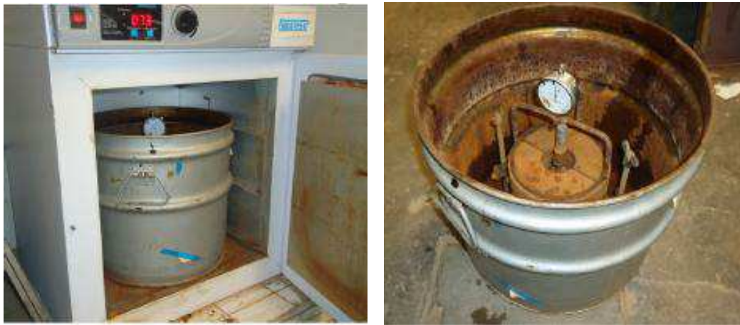
Figura 46 – Realização do ensaio de expansão da escória
