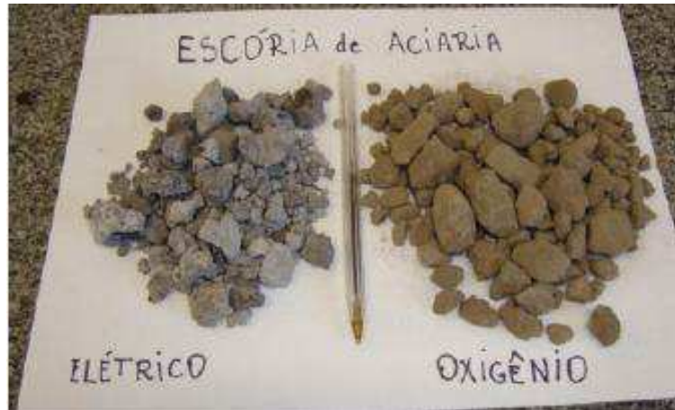
Figura 27 – Diferenças entre AS produzido em EAF e LD
