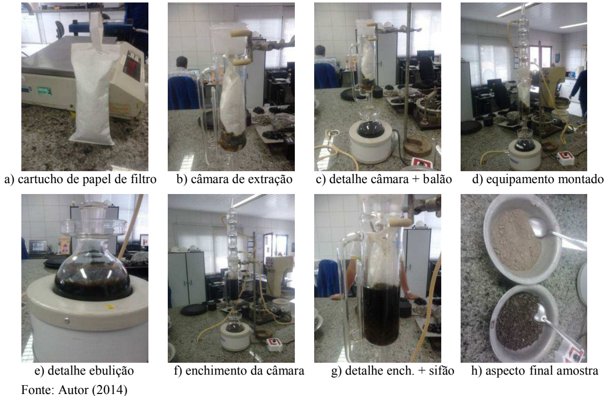
Figura 48 – Extração de betume com equipamento Soxhlet
