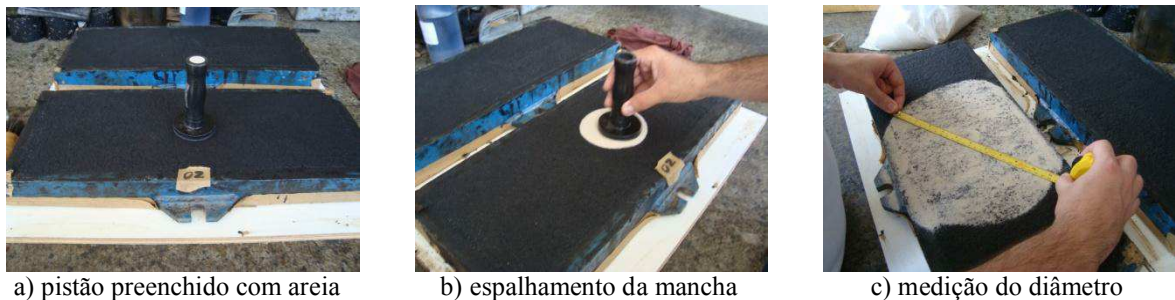
Figura 65 – Ensaio de Mancha de Areia
