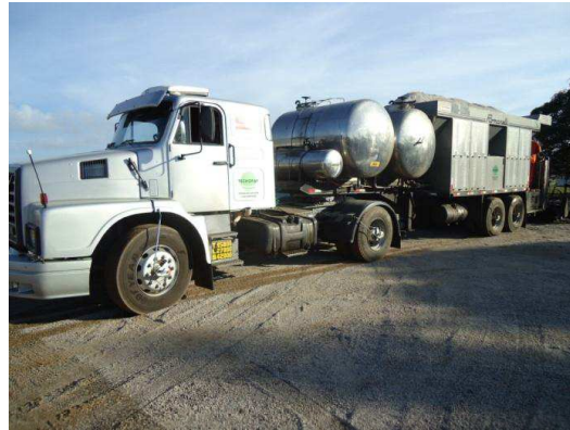
Figura 14 – Usina móvel de MRAF atrelada a um cavalo mecânico
