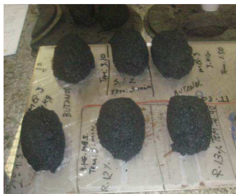
Figura 56 – Aspecto do MRAF após realização do ensaio de tempo mínimo de misturação
