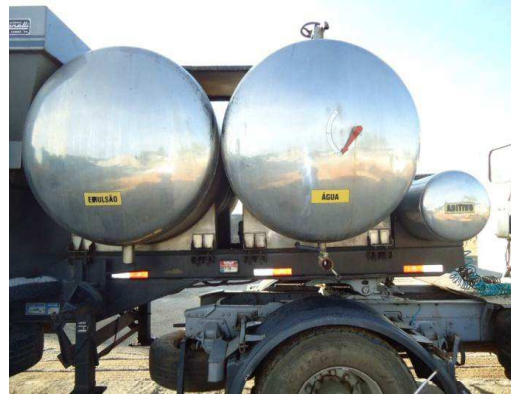
Figura 17 – Tanques de armazenamento de emulsão, água e aditivos
