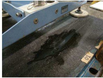
a) detalhe molhagem prévia do revestimento
