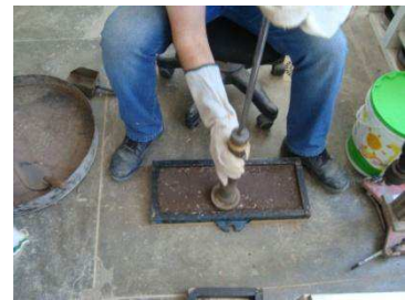
c) compactação da placa
