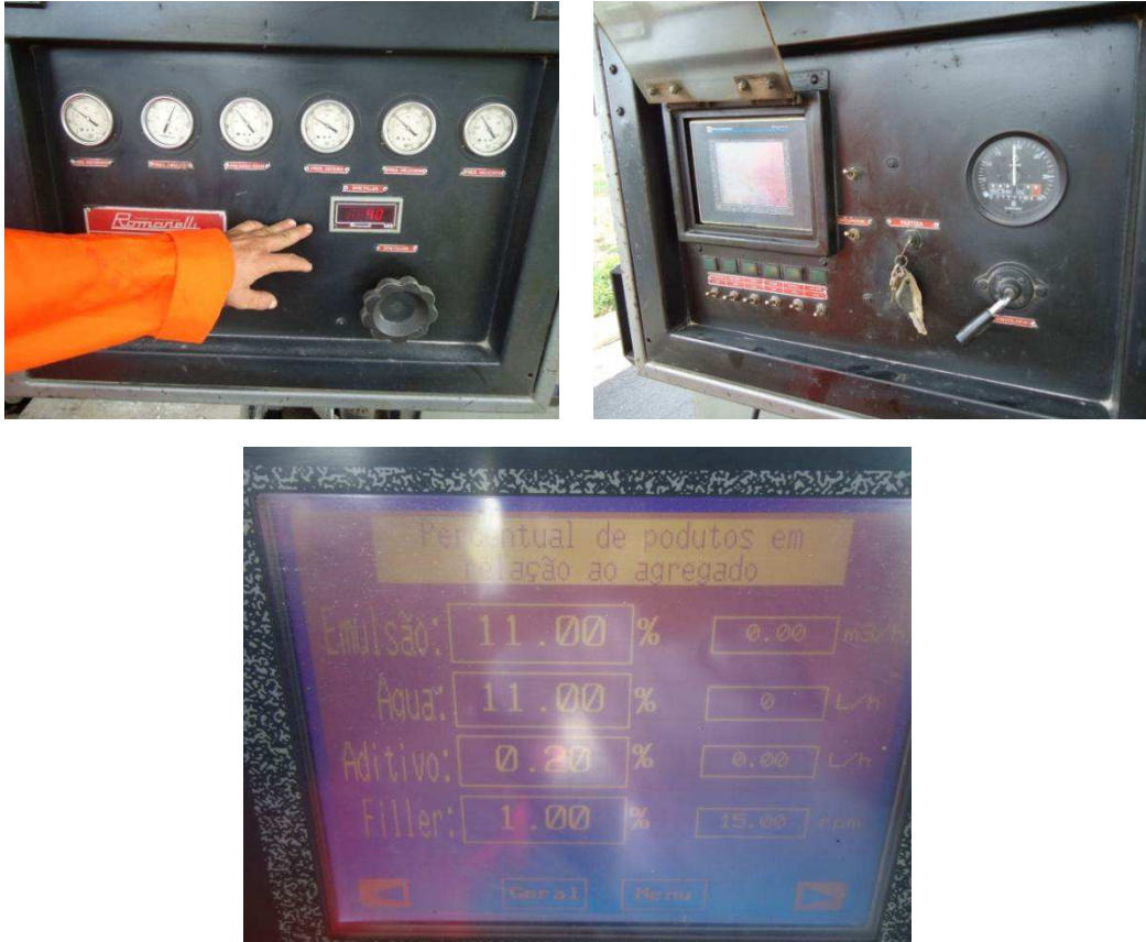
Figura 23 – Controle e dosagem da aplicação do MRAF
