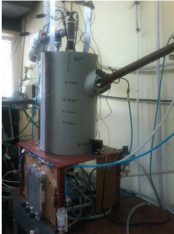
Figura 44 — Configuração do queimador poroso com lança-chamas
