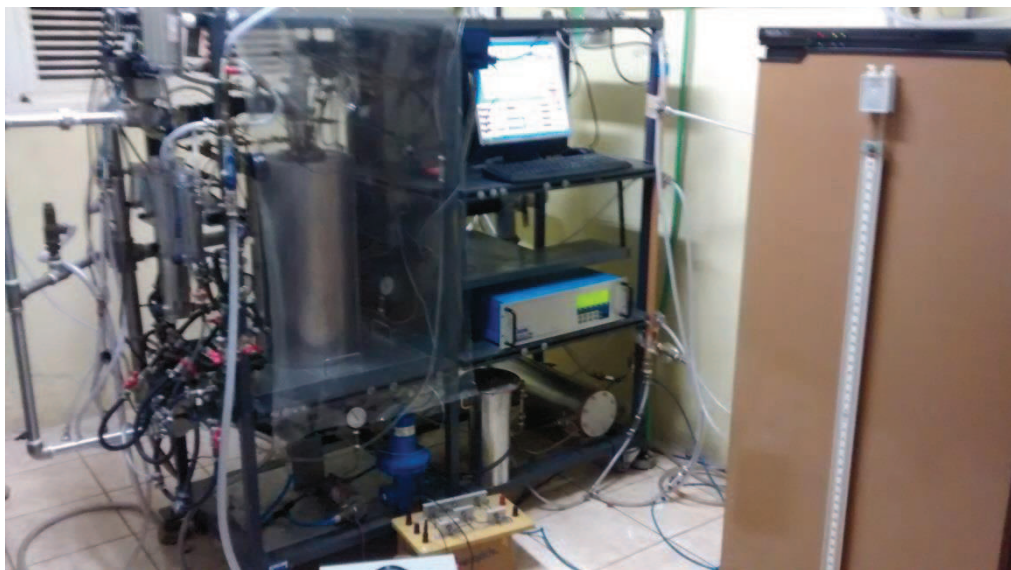
Figura 43 — Configuração da caldeira e instrumentos de medição
