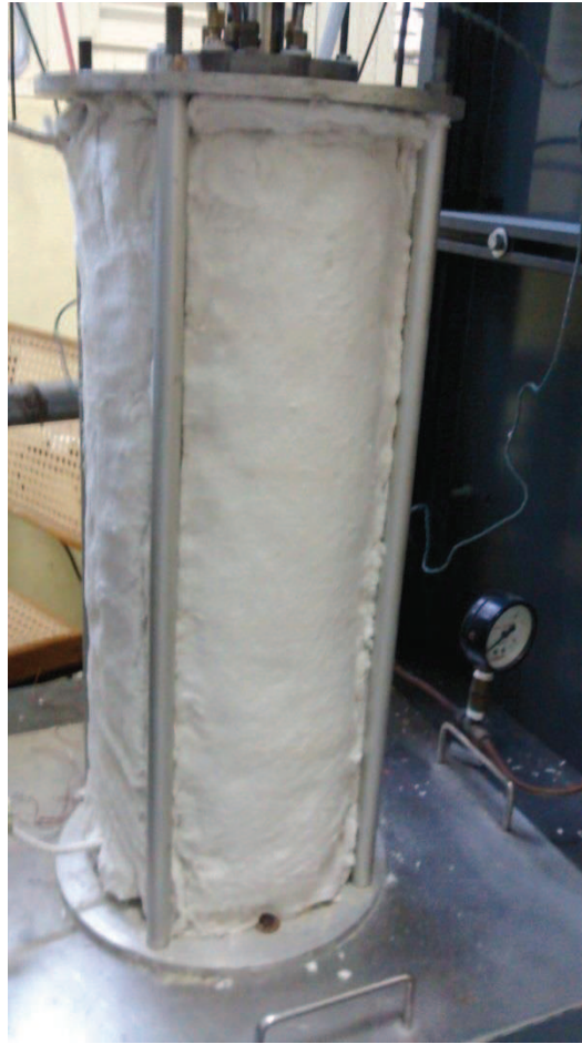
Figura 42 — Configuração da caldeira antes de ser fechada
