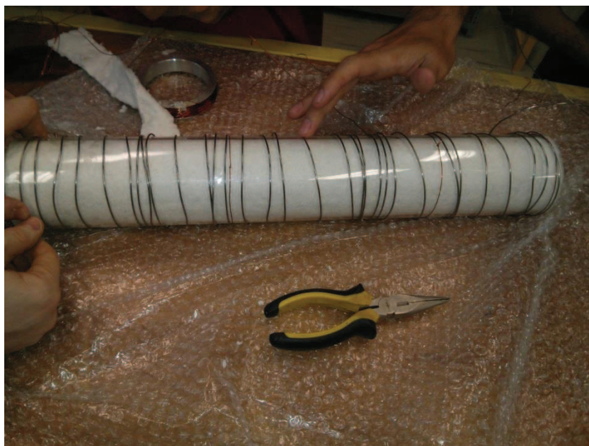
Figura 34 — Configuração do fio resistivo no tubo de quartzo
