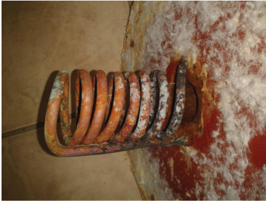
Figura 37 — Trocador de calor após experimentos no queimador
