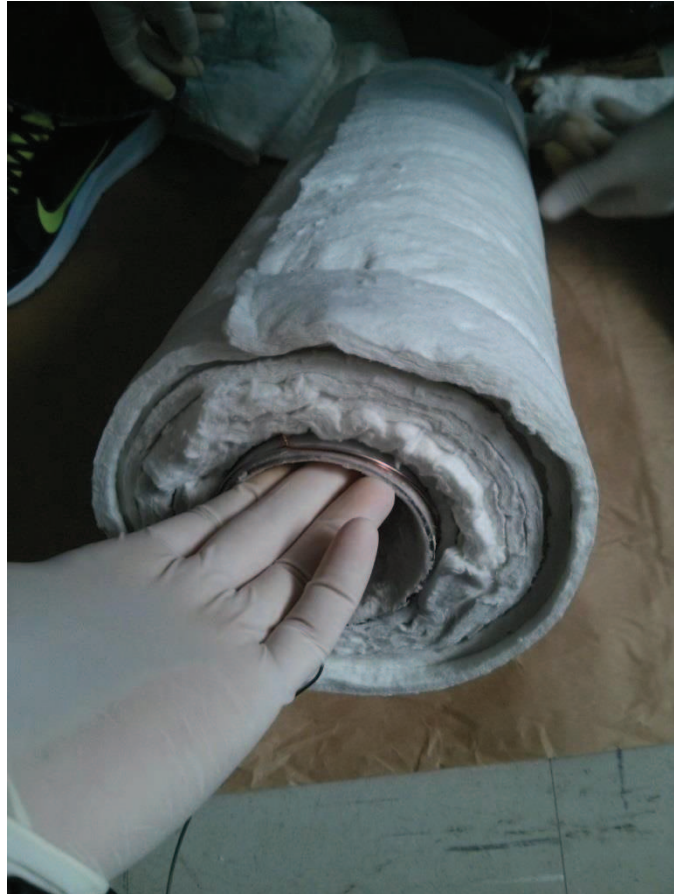
Figura 32 — Vista superior do isolamento do tubo de quartzo
