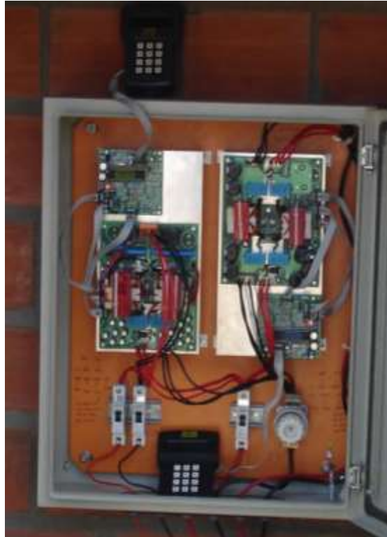
Figura 42 - Fotografia do Carregador de Baterias (direita) e Conversor Elevador (esquerda) montados na comunidade Malícia
