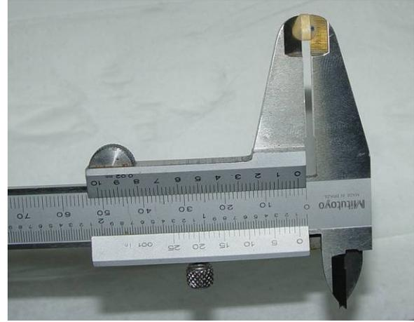
FIGURA 12 - Aferição da espessura dos espécimes com paquímetro
