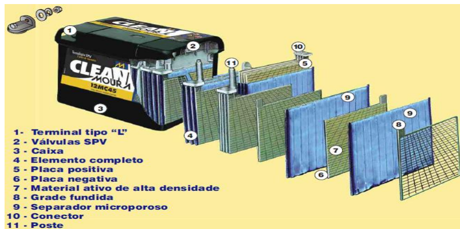
Figura 2.1 - Composição de uma bateria comercial de chumbo-ácido.
