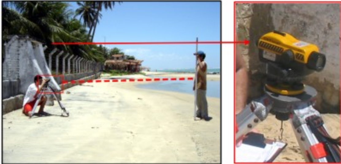
Figura 1.4: Metodologia usada para medir o perfil horizontal de cada transecto na Praia de Paracuru-Ce. Segundo Emery (1961) e Muehe (2002). À direita, o aparelho usado para verificação da heterogeneidade do relevo de cada transecto.
