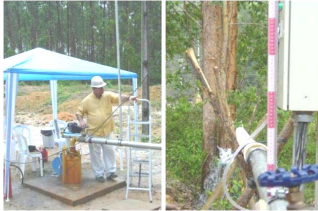
Figura 100 - Equipamento de orifício circular para medidas de vazão constante.
