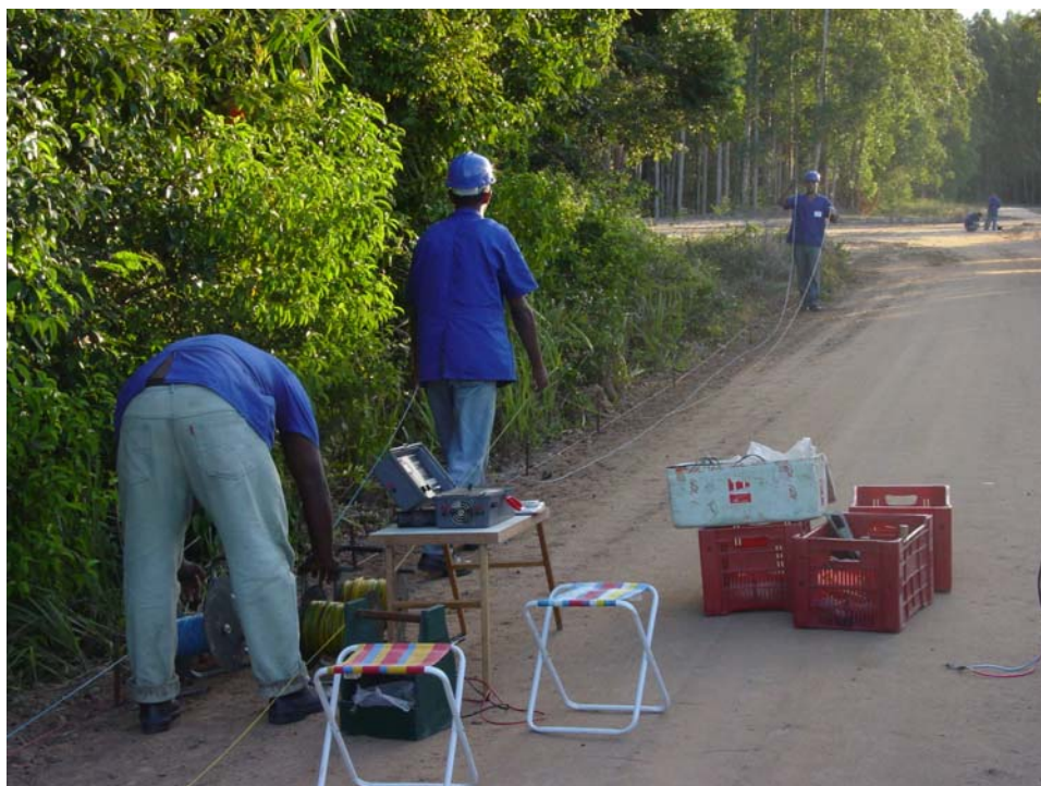
Figura 39 - Centro da SEV FAL-06 onde se localiza o equipamento e posicionamento dos eletrodos.
