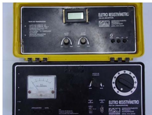
Figura 35 - Eletrorresistívmetro PER 500 constituído de fonte de 500W e receptor geração de corrente I e medida da diferença de potencial DV.
