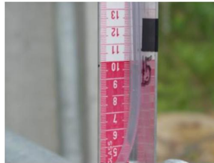
Figura 99 - Escoador de orifício circular durante a calibração no poço FAL-40.
