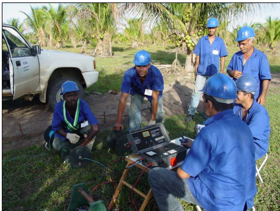
Figura 40 - Centro da SEV FAL-05 e vista do equipamento de eletrorresistividade.
