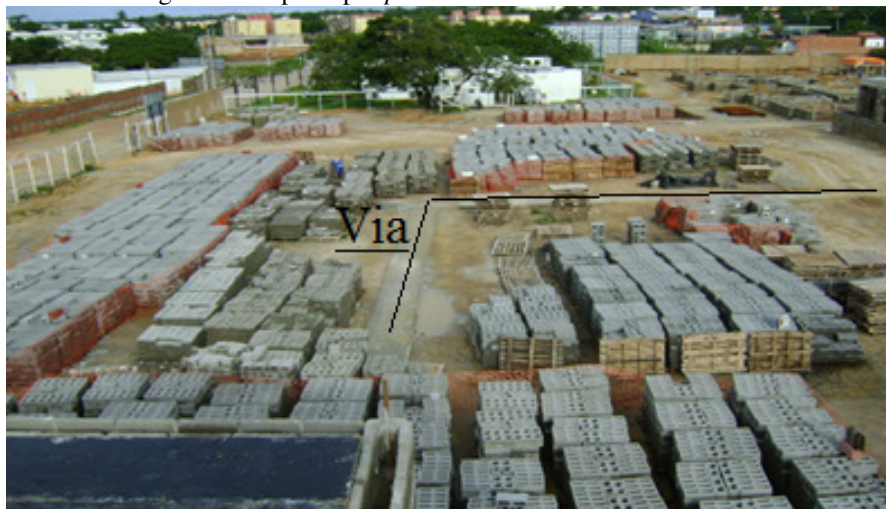
Figura 51 - Sistema de estocagem e transporte por pallet
