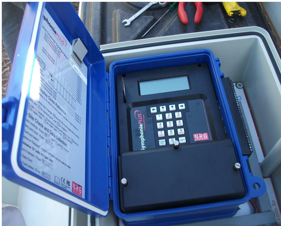
Figura 20: *Data logger* instalado na torre em estudo. Fonte: próprio autor
