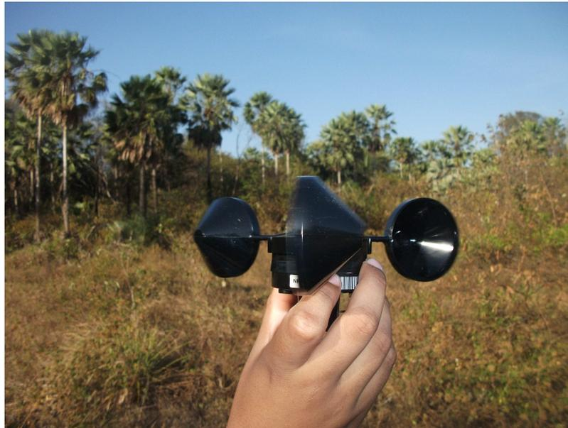
Figura 21: Tipo de anemômetro instalado na torre de Maracanaú. Fonte: próprio autor
