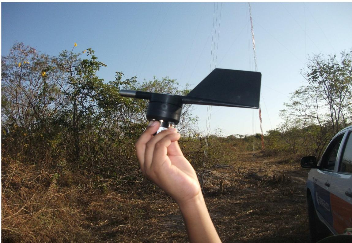
Figura 23: Sensor de direção instalado na torre de Maracanaú. Fonte: próprio autor
