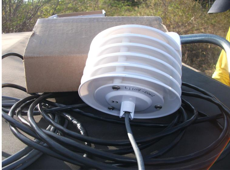
Figura 24: Tipo de sensor de temperatura instalado na torre de Maracanaú. Fonte: próprio autor
