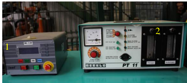
Figura 18 – Controle de movimentação da tocha (1); fluxômetro para controle da vazão de gás plasma e de arraste (2).
