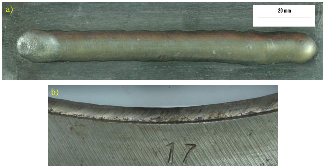
Figura 79 – Condição 17 ( I = 130 A, V_s = 7 cm/min, R_c = 1,0 mm, TA = 16 g/min e VGA = 5 l/min).
