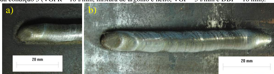
Figura 59 - a) Pós não fundidos no final do cordão de solda; b) Vista superior do cordão soldado da condição 3 (VGPR – 10 l/min, mistura de argônio e hélio, VGP – 5 l/min e DBP – 16 mm).
