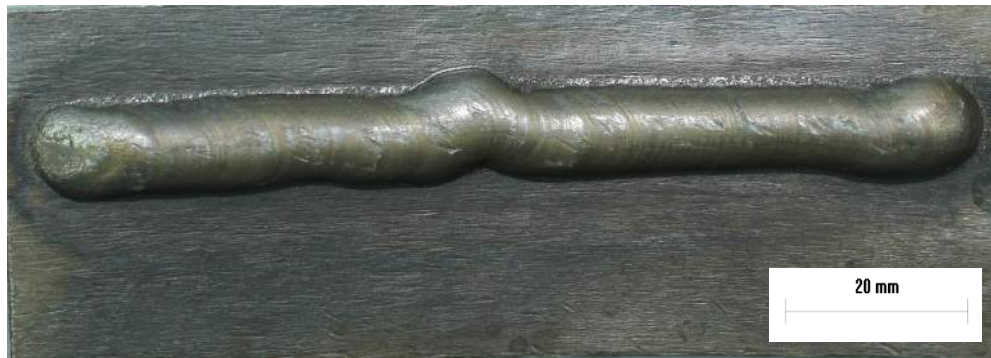
Figura 78 – Condição 13 ( I = 130 A, V_s = 9 cm/min, R_c = 0 mm, TA = 19 g/min e VGA = 5 l/min).
