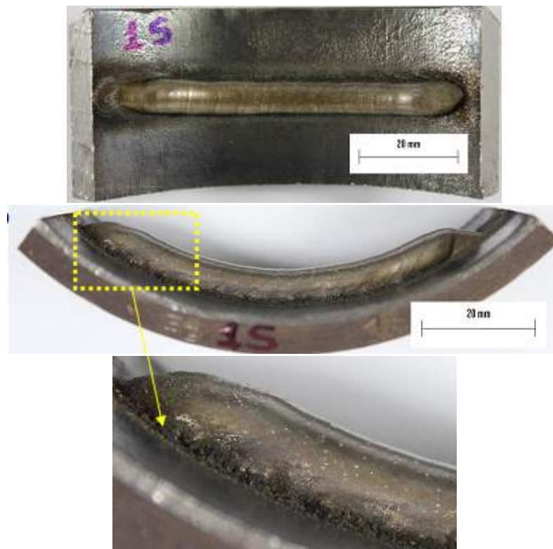
Figura 45 - Aspecto superficial do cordão para condição 1 ( E = 11,7 \text{ kJ/cm} , I = 75 \text{ A} , V_s = 9 \text{ cm/min} ). a) Vista superior; b) Vista lateral; c) Vista lateral ampliada.
