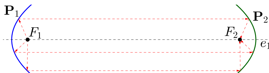
Figura 122 – Ondas emitidas de F_1 , foco de P_1 para P_2 .
