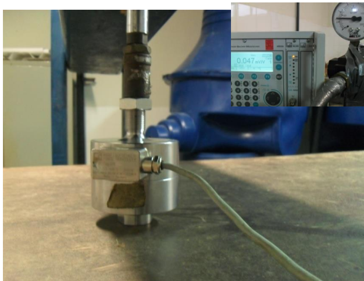
Figura 41 - Calibração da carga aplicada pela célula de carga.
