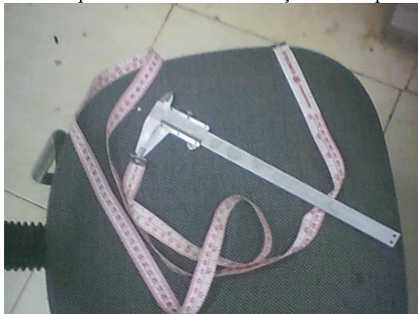
Figura 4.5 – Paquímetro utilizado nas medições dos corpos de prova
