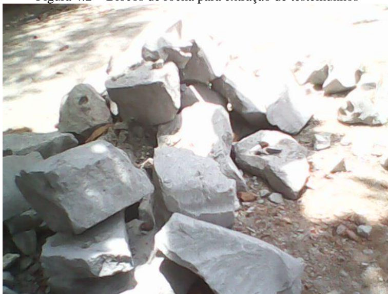
Figura 4.2 – Blocos de rocha para extração de testemunhos
