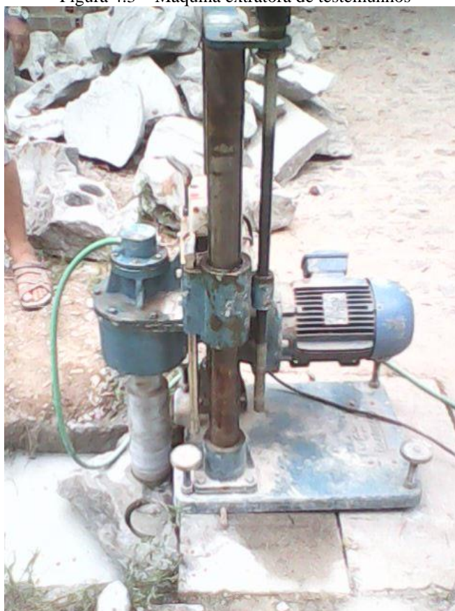
Figura 4.3 – Máquina extratora de testemunhos
