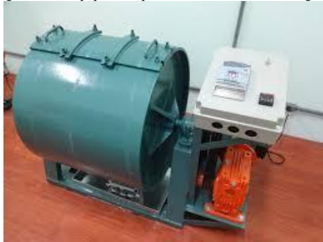
Figura 2.15 – Equipamento para ensaio de Abrasão Los Angeles.
