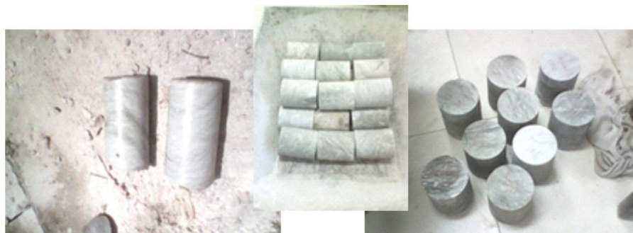
Figura 4.4 – Corpos de prova extraídos e cortados de acordo com as normas da NBR 7680/07 (ABNT, 2007)
