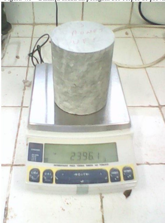
Figura 4.6 – Balança usada na pesagem dos corpos de prova
