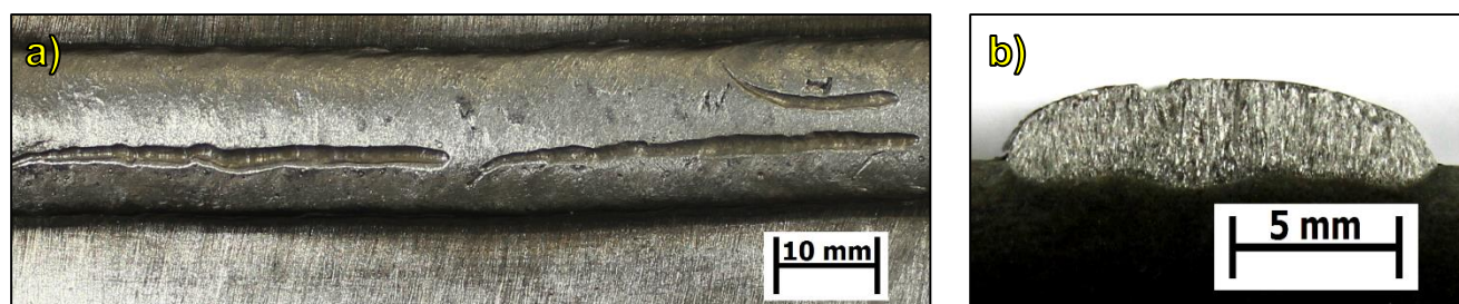
Figura 59 - a) Aspecto superficial e b) seção transversal do cordão de solda para o Ensaio 06 (Liga=2507, Gás=96%Ar + 4%CO 2 , E= 2,0 kJ/mm, T.E= Tipo V, Tecimento= ST, T.T= Empurrando e DBCP= 15 mm).
