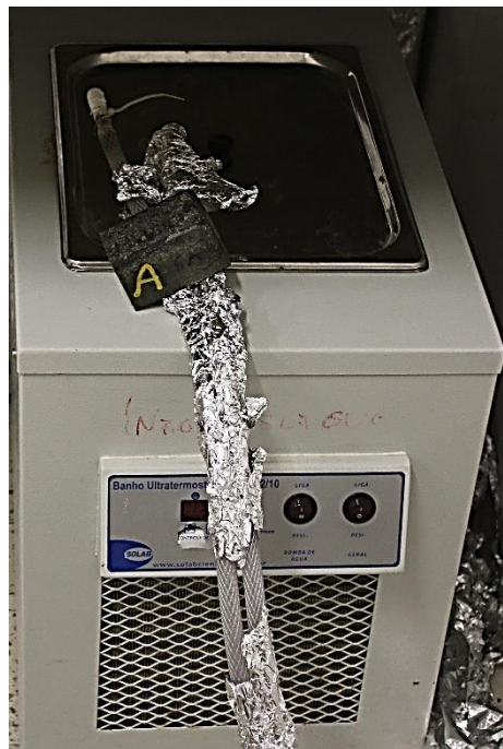
Figura 35 - Banho Ultratermostático para realização de ensaio ASTM G150.
