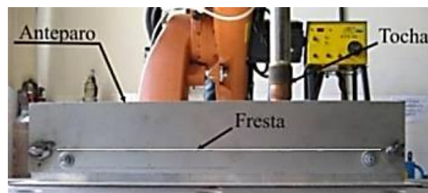
Figura 33 - Anteparo com fresta para determinação do comprimento do arco.
