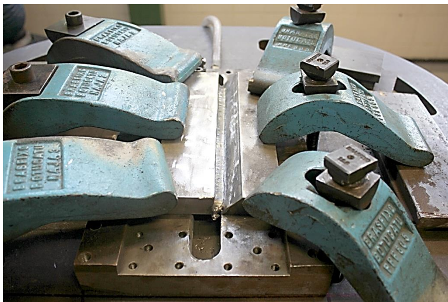
Figura 42 - Montagem da junta sobre a mesa de trabalho.
