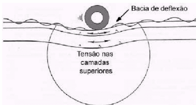
Figura 3. Ilustração do efeito da ação de cargas móveis no pavimento.
