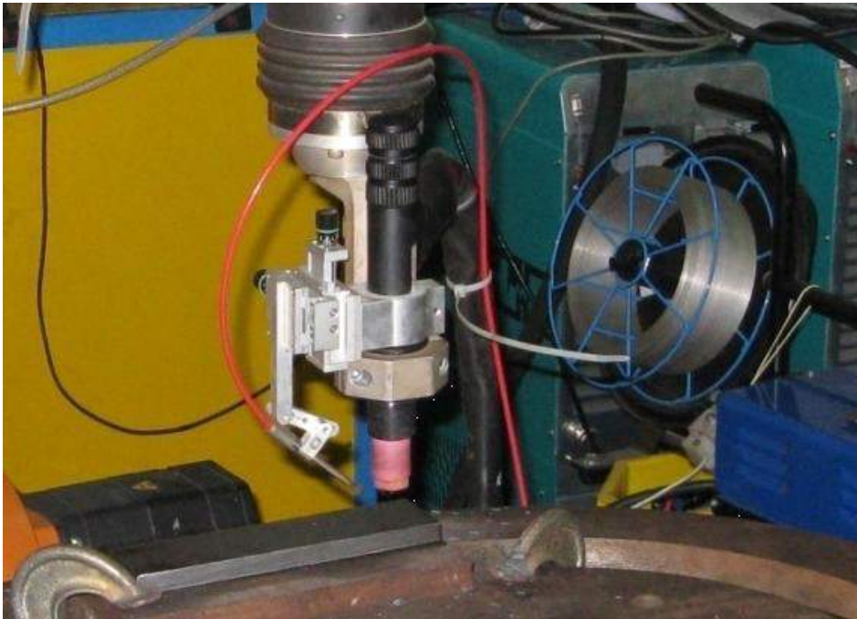
Figura 8 - Tocha GTAW com sistema de posicionamento para alimentação de arame frio (Silva, 2010).
