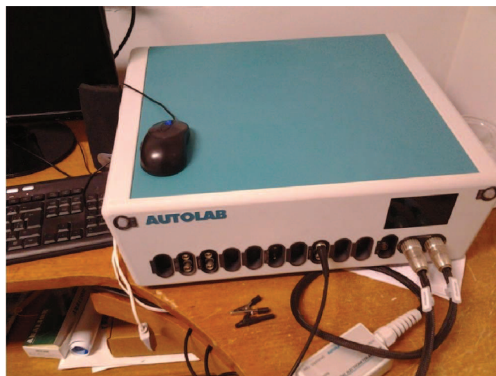
Figura 12 Potenciostato / Galvanostato modelo PGSTAT302N Autolab.
