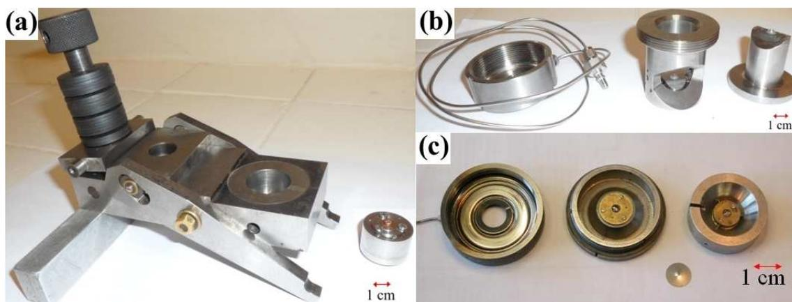
Figura 14: (a) Célula de pressão NBS que pode realizar estudos de altas pressões com limite de 10 GPa. Célula panorâmica (b) e célula fechada (c) projetada para realizar experimentos até 30-40 GPa.
