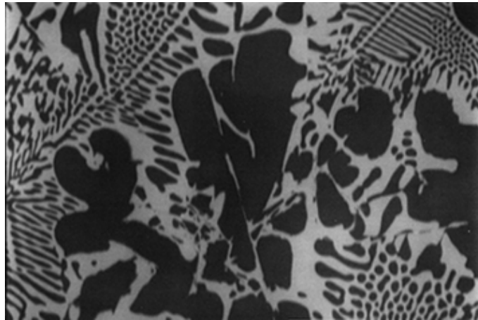
Figura 2.11. Imagem por SEM de uma liga de cobre e de alumínio formada usando elétrons retro-espalhados. A área clara é formada principalmente de cobre e a área escura é de alumínio.
