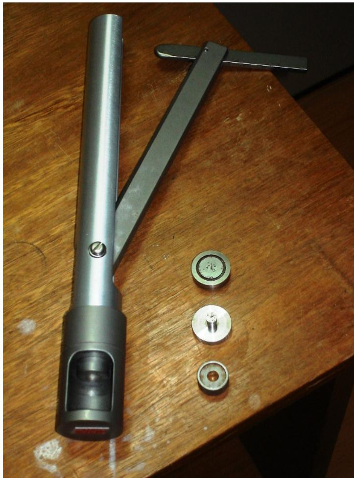
FIGURA 3.2 - À esquerda, Prensa manual usada para compactar a mistura para a formação do disco. À direita, matriz usada na compactação da mistura composta de três partes.
