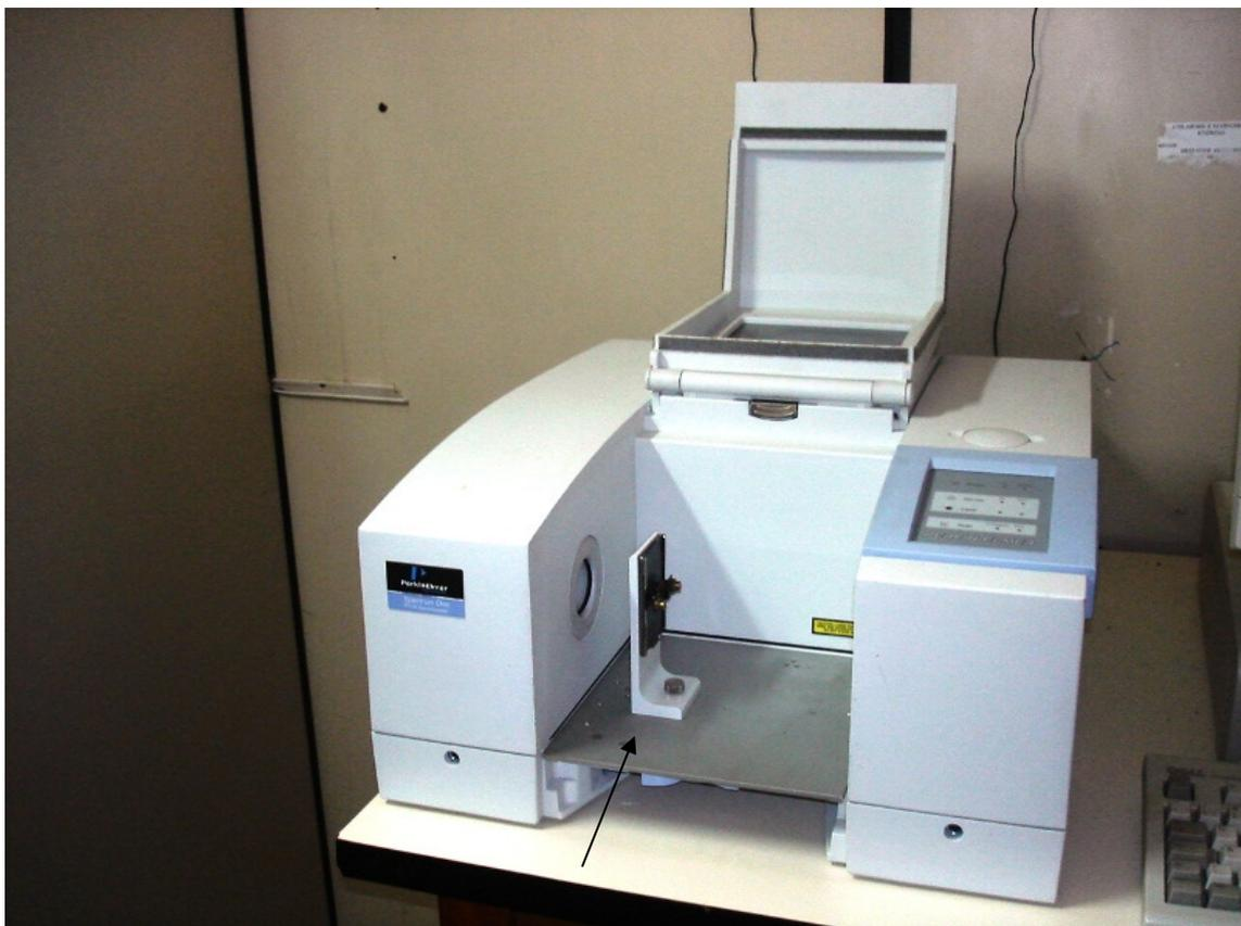
FIGURA 3.3 Espectrômetro *Spectrum One* usado nas medidas de absorção no infravermelho. O disco de KBr é preso ao acessório indicado pela seta.
